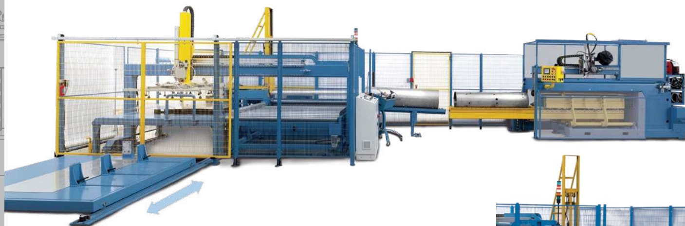
⏩ ⏪ Полуавтоматическая линия для сварки обечаяек.
