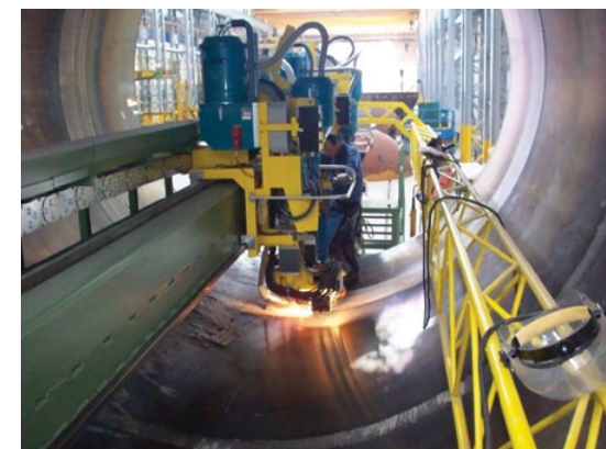
⏩ Специализированная установка для наплавки ленточным электродом.
