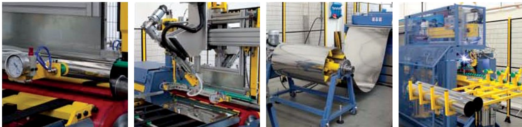
⏪ ⏩ Автоматическая линия для сварки труб дымоходов.
