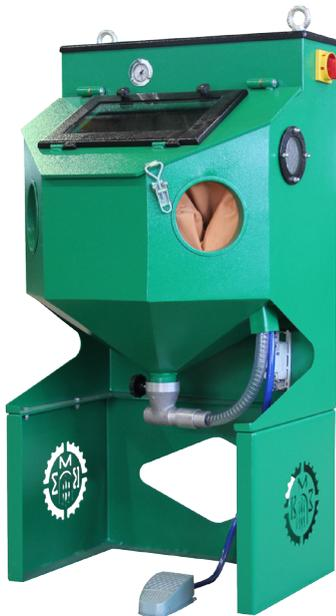
Камера струйная **КСО® – 60 – И** с инжекторным способом формирования воздушно-абразивной смеси предназначена для снятия ржавчины, песка и окалины, получения необходимой шероховатости, снятия слоёв, матирования, упрочнения, снятия заусенцев и полирования, а так же для подготовки поверхностей перед нанесением антикоррозионных покрытий (лакокрасочных материалов, металлизационных покрытий).
