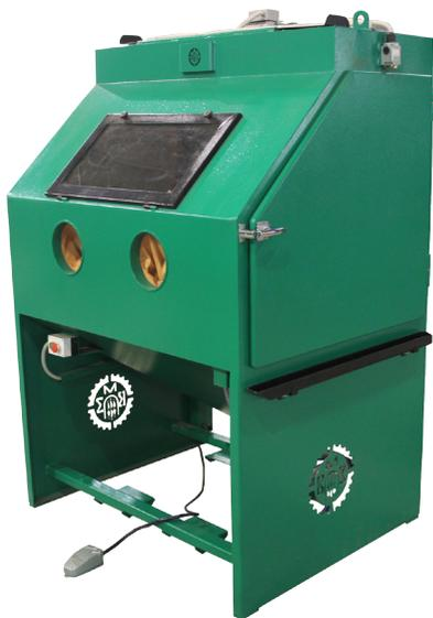
Камера струйная КСО® – 130 – И с инжекторным способом формирования воздушно-абразивной смеси предназначена для снятия ржавчины, песка и окалины, получения необходимой шероховатости, снятия слоёв, матирования, упрочнения, снятия заусенцев и полирования, а так же для подготовки поверхностей перед нанесением антикоррозионных покрытий (лакокрасочных материалов, металлизационных покрытий).
