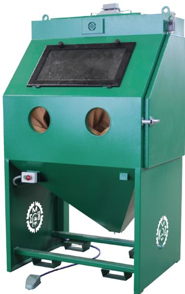
Камера струйная **КСО® – 110 – И** с инжекторным способом формирования воздушно-абразивной смеси предназначена для снятия ржавчины, песка и окалины, получения необходимой шероховатости, снятия слоёв, матирования, упрочнения, снятия заусенцев и полирования, а так же для подготовки поверхностей перед нанесением антикоррозионных покрытий (лакокрасочных материалов, металлизационных покрытий).
