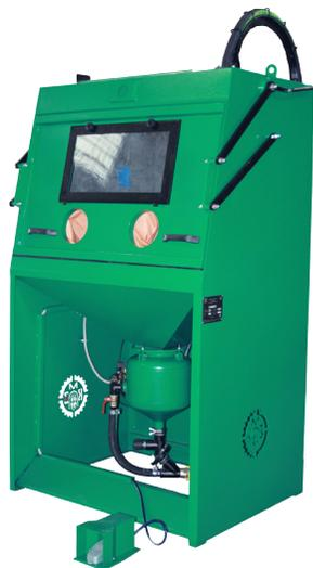
Камера струйная «КСО 130® – Н» с напорным способом формирования воздушно-абразивной смеси предназначена для снятия ржавчины, песка и окалины, получения необходимой шероховатости, снятия слоёв, матирования, упрочнения, снятия заусенцев и полирования, а так же для подготовки поверхностей перед нанесением антикоррозионных покрытий (лакокрасочных материалов, металлизационных покрытий).
