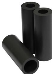
Сопло из карбида бора (B4C) с каналом «Цилиндр»  $\varnothing$  6мм;  $\varnothing$  8мм;  $\varnothing$  10мм для пистолетов инжекторных SGI, длина 51 мм.
