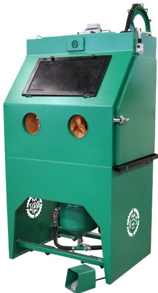
Камера струйная **КСО 110® - Н** с напорным способом формирования воздушно-абразивной смеси предназначена для снятия ржавчины, песка и окалины, получения необходимой шероховатости, снятия слоёв, матирования, упрочнения, снятия заусенцев и полирования, а так же для подготовки поверхностей перед нанесением антикоррозионных покрытий (лакокрасочных материалов, металлизационных покрытий).
