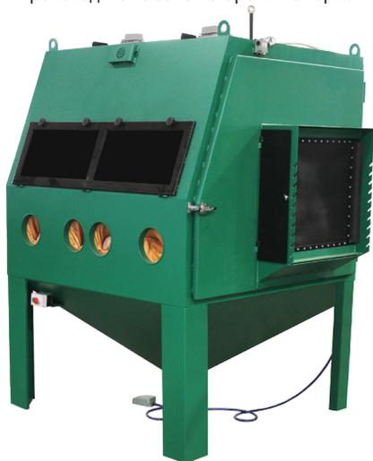
Камера струйная **КСО® – 150 – И** с инжекторным способом формирования воздушно-абразивной смеси предназначена для чистки металлических поверхностей от ржавчины, песка и окалины, получения необходимой шероховатости, снятия старых слоёв покрытий, матирования, упрочнения, снятия заусениц и полирования, а так же для подготовки поверхностей перед нанесением антикоррозионных покрытий (лако-красочных материалов, металлизационных покрытий).
