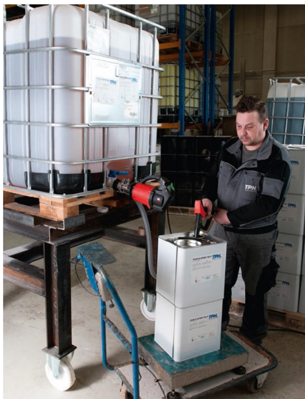
Быстрая перекачка через выпускное отверстие IBC-контейнера в емкость.
