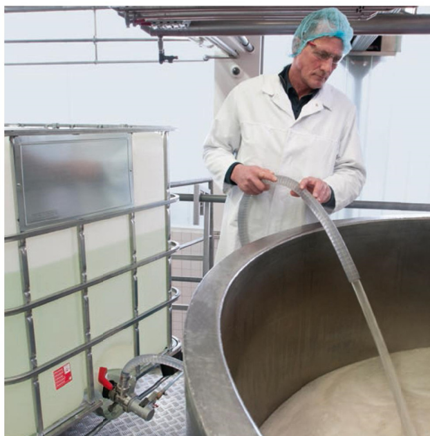
Перекачка из выпускного отверстия IBC-контейнера в емкость для смешивания.
