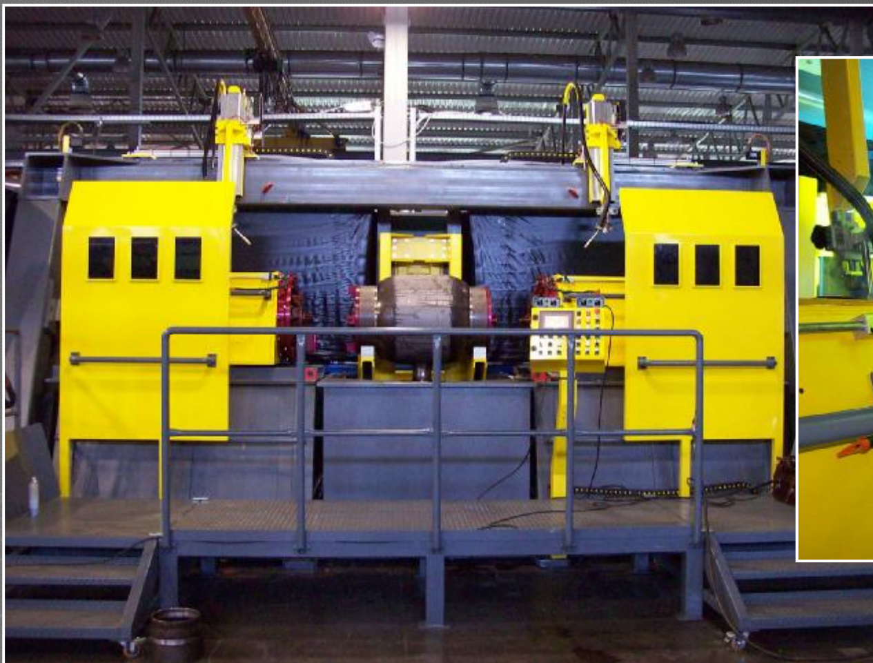
Машина для сварки двух кольцевых швов корпуса крана (Ду300 - Ду600)
