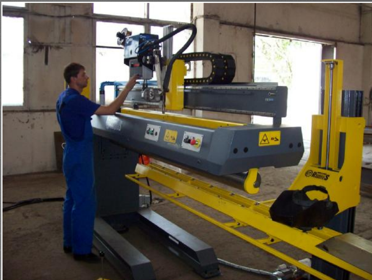
Автоматизация технологии MIG-пайки продольных швов труб из оцинкованной стали
