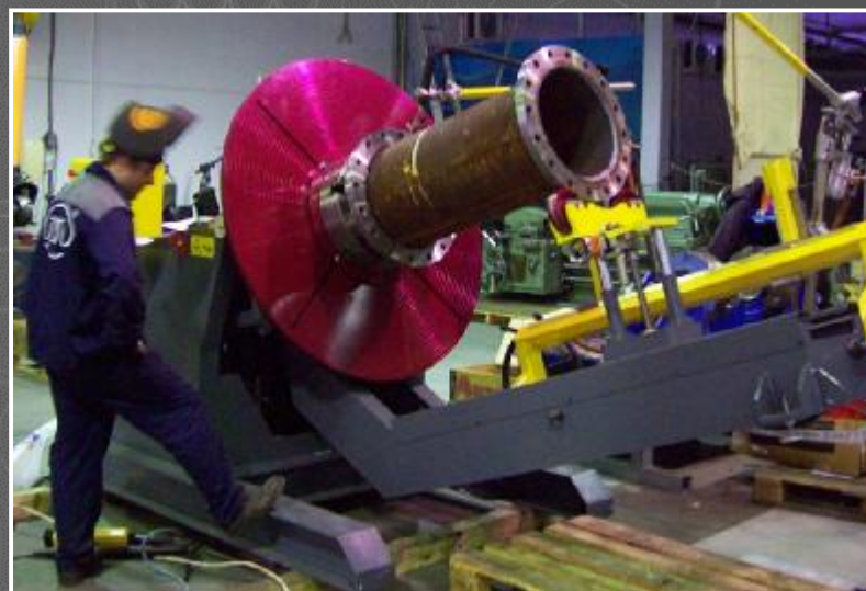
Вращатель для приварки фланцев к деталям трубопроводной арматуры
