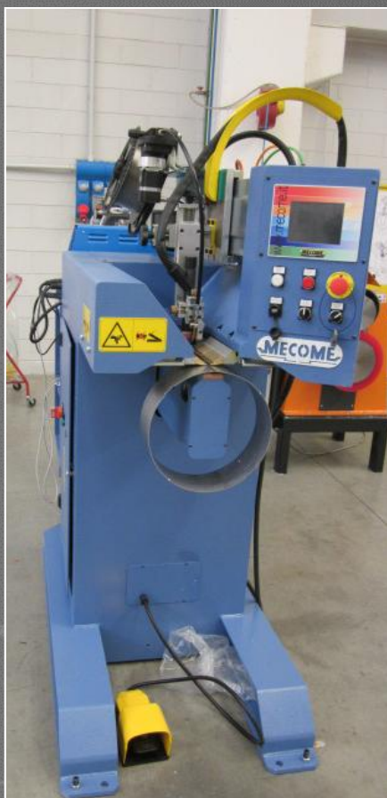
Машины для TIG сварки продольных швов и горловин пивных кег
