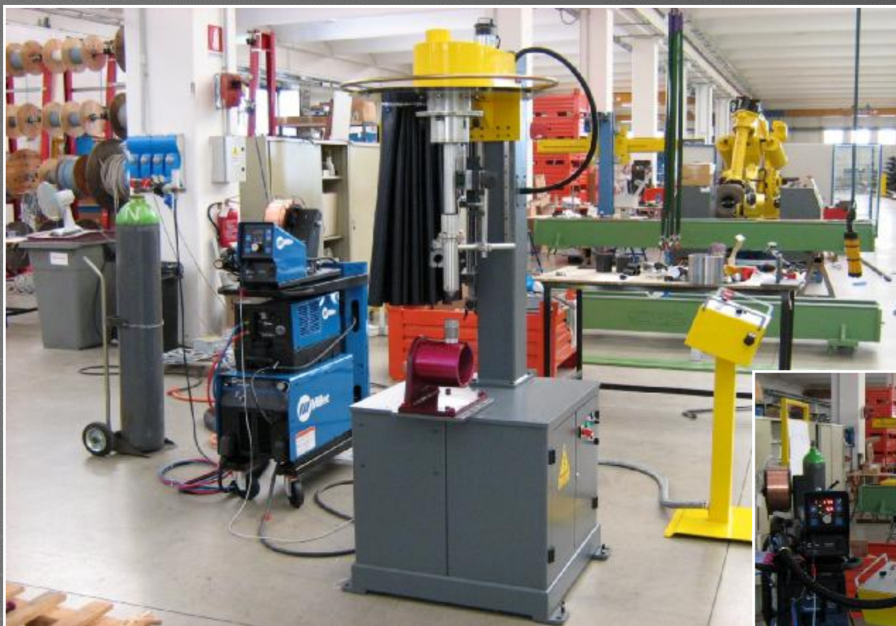
Автоматизация технологии сварки MIG, машина для приварки втулки штока
