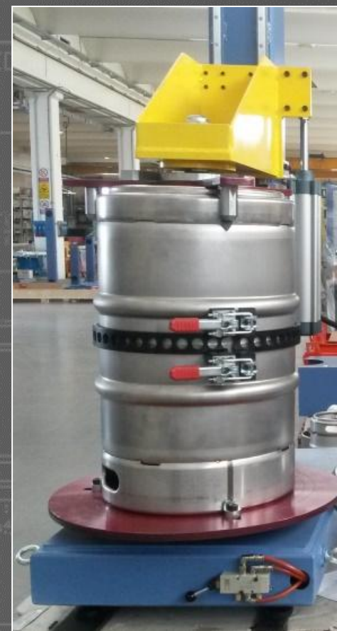
Машины для TIG сварки продольных швов и горловин пивных кег
