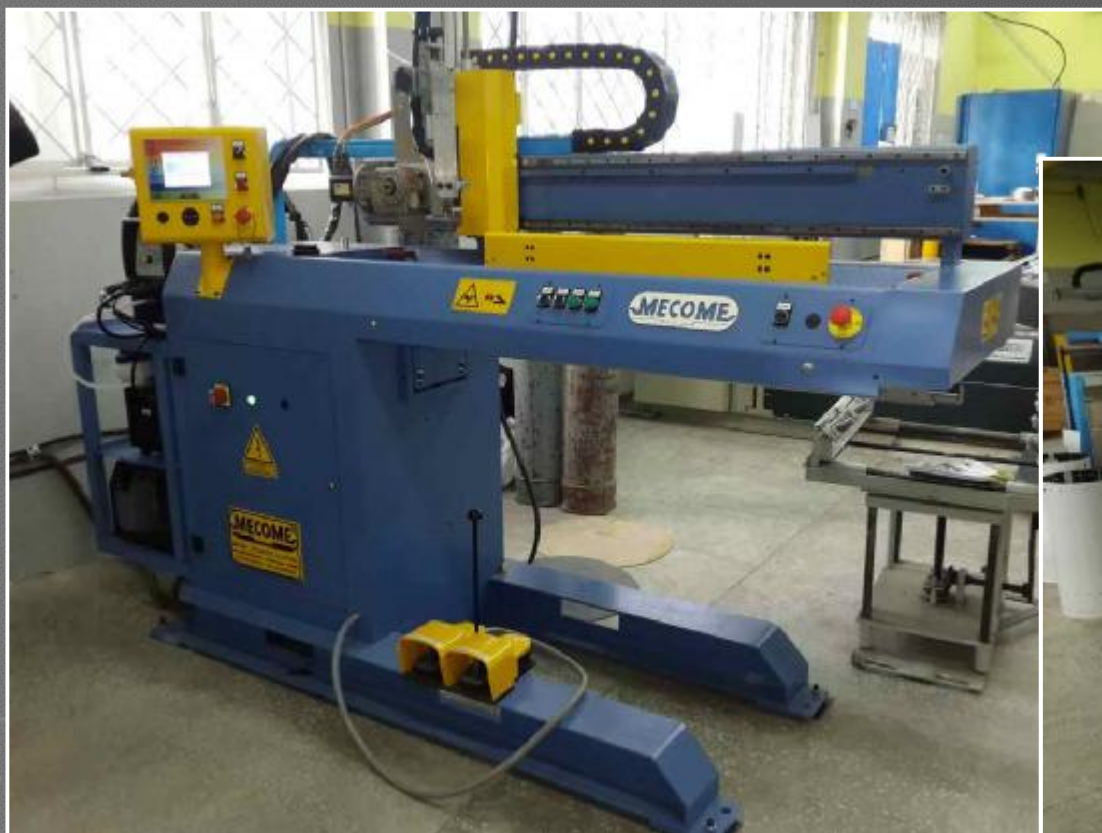
Машина для TIG сварки продольных швов дистилляторов медицинских.
