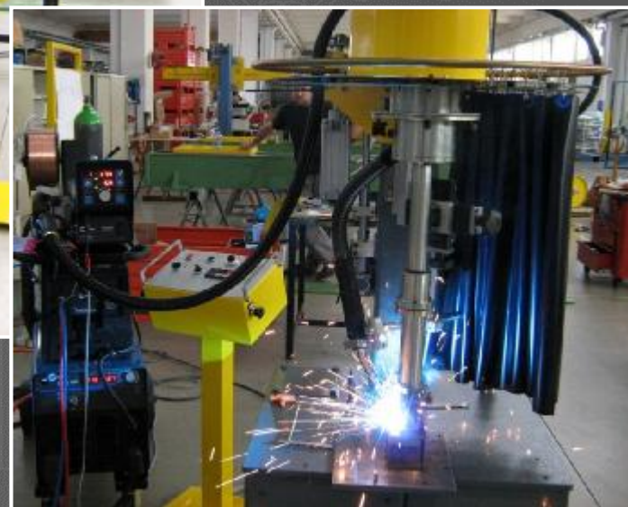
Автоматизация технологии сварки MIG, машина для приварки втулки штока
