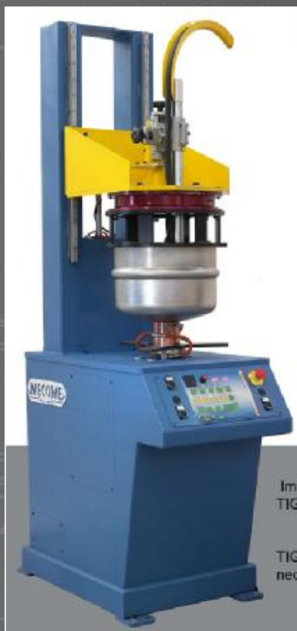
Машины для TIG сварки продольных швов и горловин пивных кег
