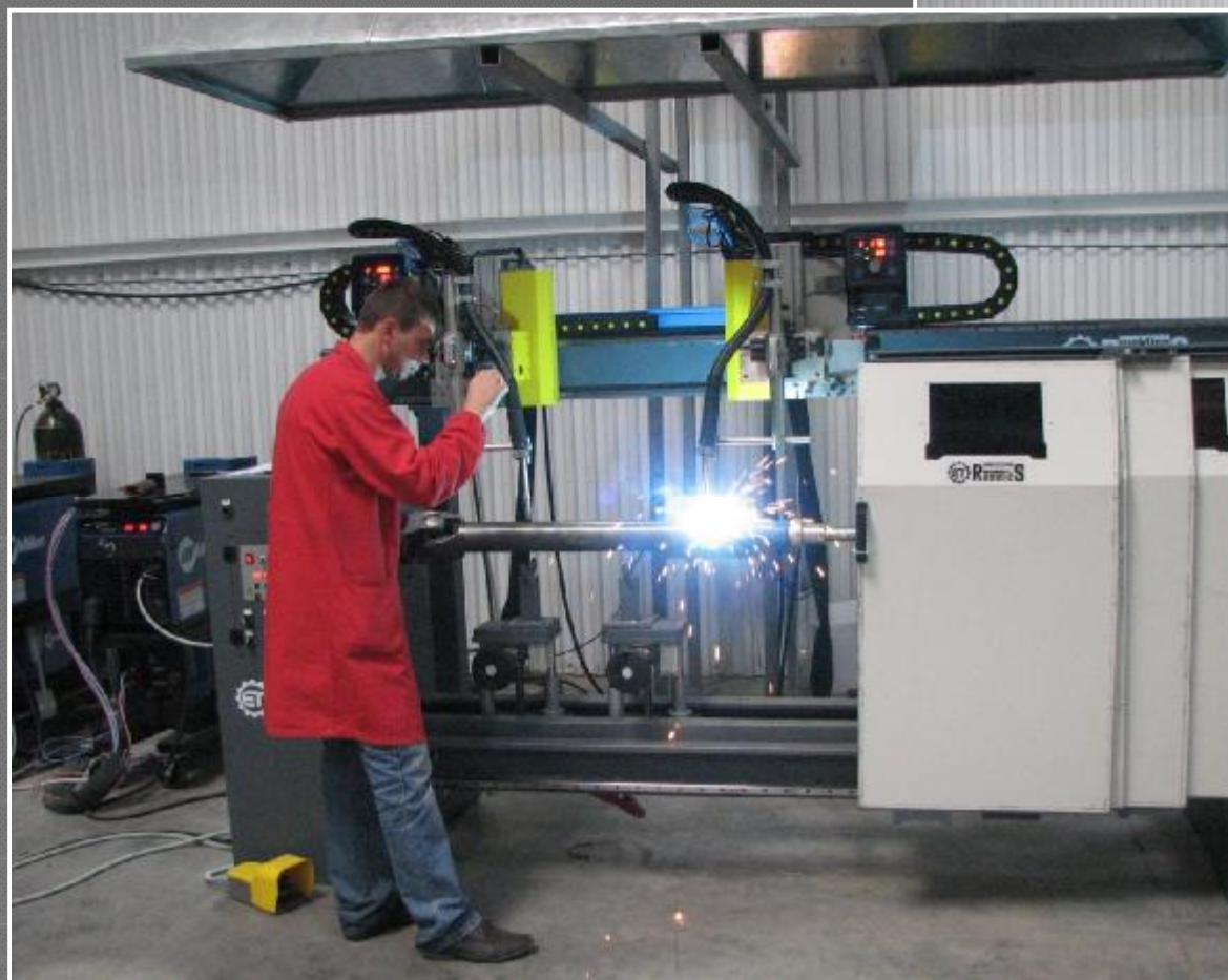
Машина для автоматической MIG сварки двух кольцевых швов
