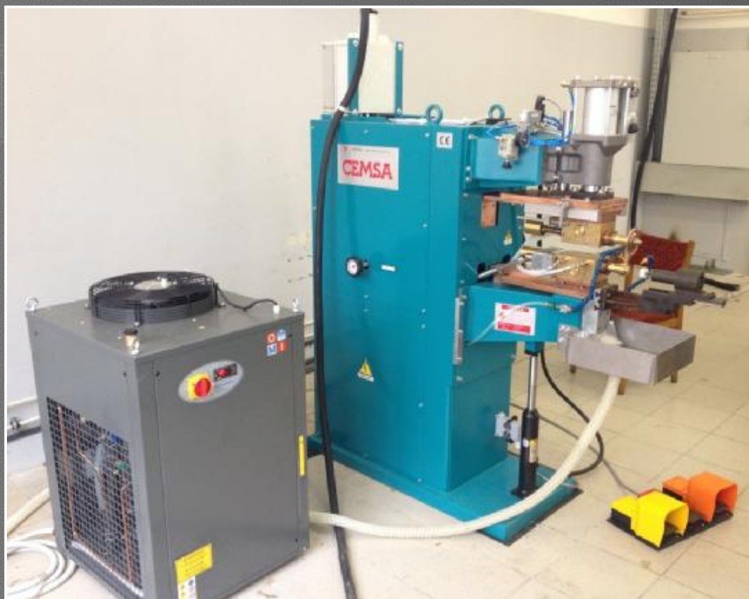
Машина для контактной шовной (роликовой) сварки сильфонов и мембран.
