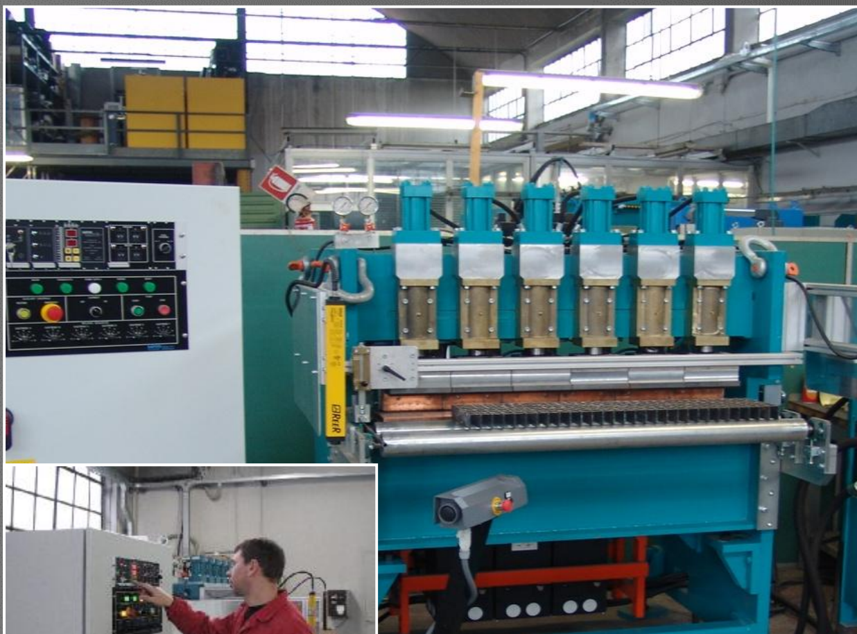
Машина для приварки пластин обрамления способом рельефной контактной сварки
