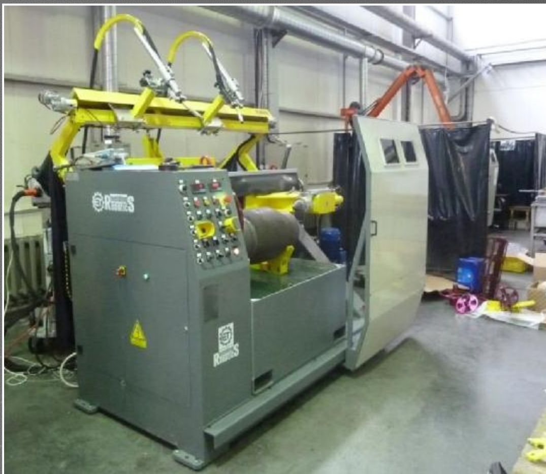
Машина для сварки двух кольцевых швов корпуса крана
