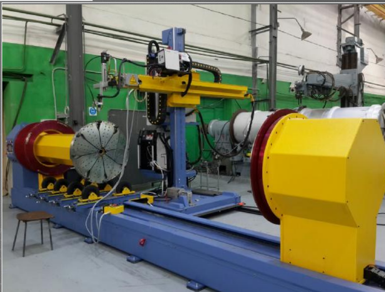
Машина для TIG сварки кольцевых швов алюминиевых обечаек длиной до 9 м
