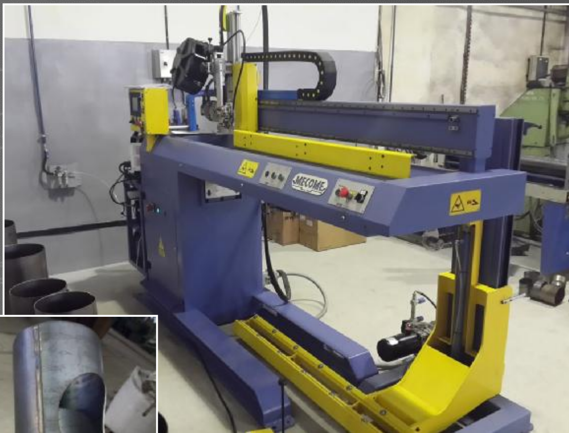
Машина для автоматической сварки продольных швов (TIG с подачей присадочной проволоки) с гидроподъемником.
