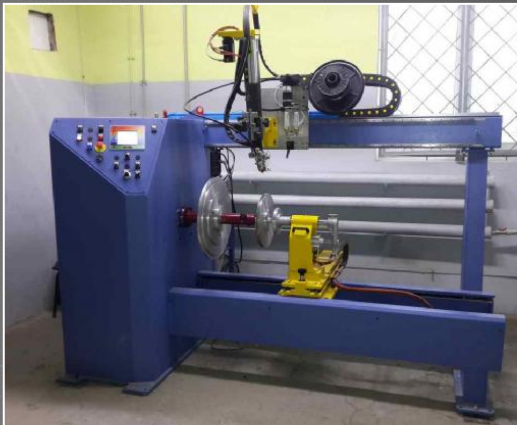
Машина для TIG сварки кольцевых швов дистилляторов медицинских.
