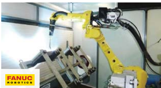
Роботизированная сварка деталей гидро-манипуляторов лесозаготовительной техники FANUC
