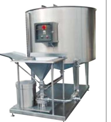
Выполнены в различных конфигурациях с или без бака. Производительность до 70 м<sup>3</sup>/ч.
