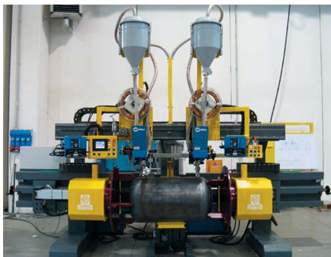
◀◀ Установка для автоматической сварки (SAW) двух кольцевых швов ресиверов, оснащенная гидравлическим устройством для загрузки и выгрузки свариваемых деталей.
