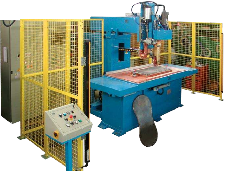
◀ ▶ Автоматическая установка для сварки моек.
