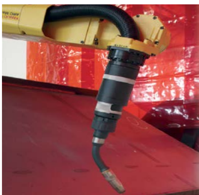
▲ ► Применение роботизированного комплекса для сварки балок.
