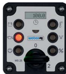
Индикатор низкого давления масла (при слишком низком давлении происходит отключение двигателя)
