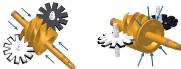
Осевые нагрузки действуют с обеих сторон главного вентя
