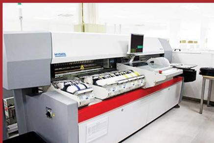
Машина размещения электронных компонентов на печатных платах
