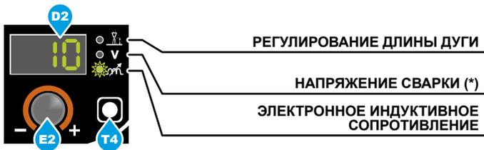
(\*) Этот параметр предварительно задается за счет синергии и может меняться при изменении параметра РЕГУЛИРОВАНИЕ ДЛИНЫ ДУГИ.
