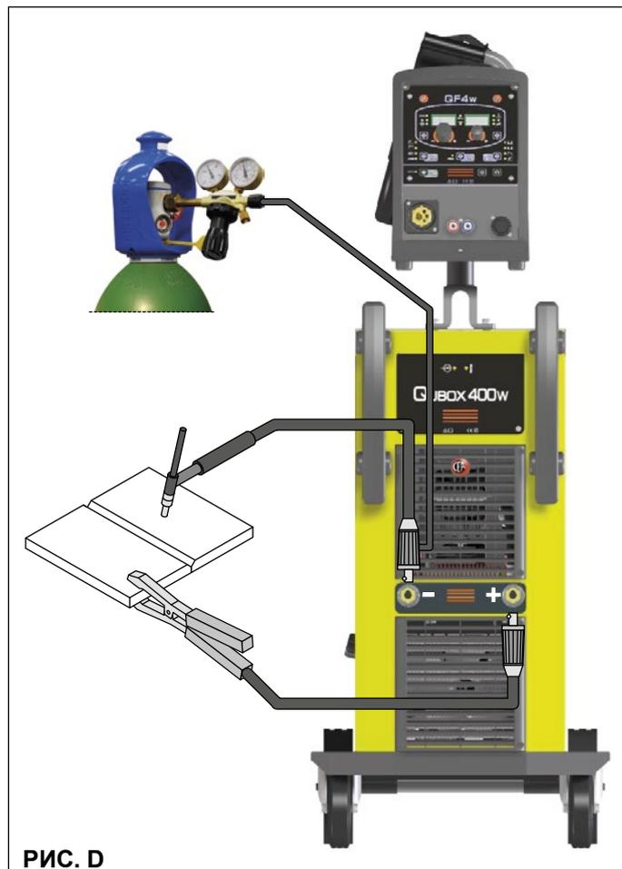
В таблице 6 приводятся значения тока для использования с соответствующими электродами для сварки ТИГ постоянного тока. Эти данные не имеют абсолютного значения, они всего лишь ориентировочны; для точного выбора соблюдайте указания производителей электродов. Диаметр используемого электрода прямо пропорционален току, используемому для сварки.
