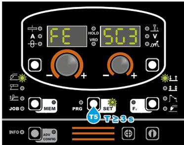
2) Отображение на двух дисплеях обеспечивается при повороте ручки КОДЕР-А (E1). Можно проверить соответствие приведенным в таблице программ механизма подачи проволоки.
