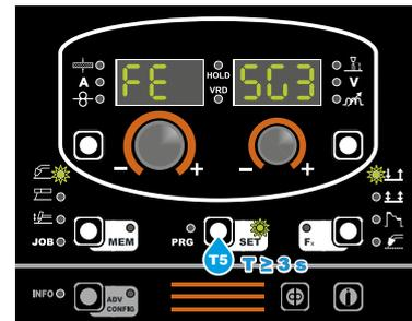
3) Поверните ручку КОДЕР-А (E1) для выбора МАТЕРИАЛА, ГАЗА и ДИАМЕТРА проволоки.
