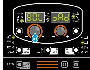
Загрузка проволоки может выполняться также при помощи кнопки ЗАГРУЗКА ПРОВОЛОКИ (T7) по этой же процедуре, используя эту кнопку вместо кнопки горелки в том же порядке. Отличие от загрузки кнопкой горелки состоит в том, что проволока достигает постоянной скорости без задержки в 2 секунды.
