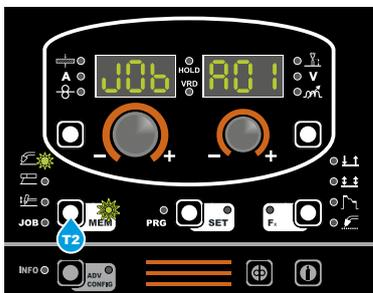
Для выбора другой свободной автоматической точки сварки (РАБОЧЕГО ЗАДАНИЯ), в которую записывать данные, достаточно повернуть одну из двух ручек КОДЕР (E1-E2) до нужной точки.
