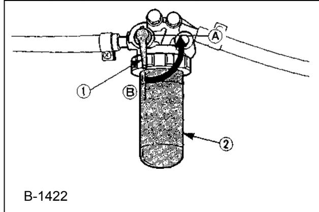
(1) Кран топливного фильтра (A) OFF/ВЫКЛ.
