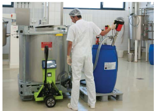
F 560 GS в работе в секторе с гигиеническими требованиями – закачивание сырья для крема в смесительную ванну
