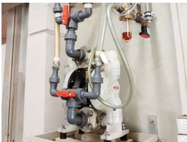
FDM Выкачивание химического никеля для гальванической ванны
