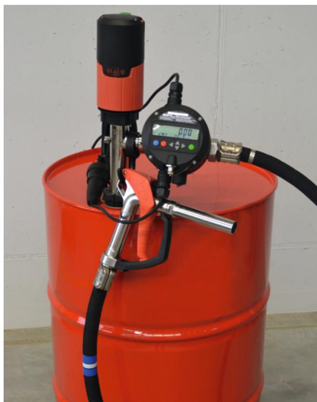
Обычный бочковой насос с расходомером FMO 104, коммутирующим усилителем FSV 100 и шлангом с раздаточным пистолетом (система с полуавтоматическим управлением).
