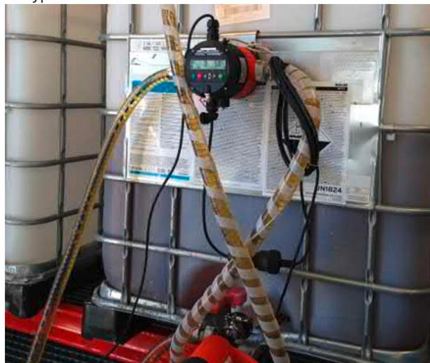
Полуавтоматическая заправочная система с расходомером FMC 100 и коммутирующим усилителем FSV 100 для стандартного IBC-контейнера.
