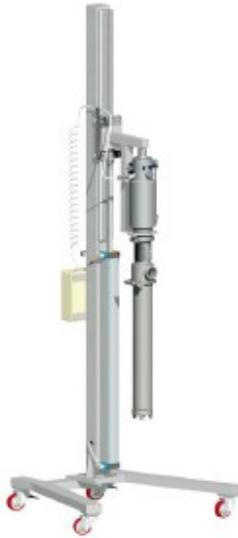
Модель с ручным подъемным скользящим устройством с помощью противовеса
