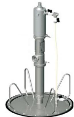
Передвижная установка с двойными пневматическими поршнями для больших емкостей с вязким продуктом, включающая поршневой пневмонасос и скребок. Подходит для смесей, джемов, кремов и т.д., транспортируемых после обработки.
