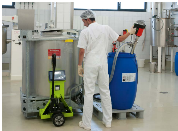
F 560 GS в работе в секторе с гигиеническими требованиями – закачивание сырья для крема в смешивательную ванну.
