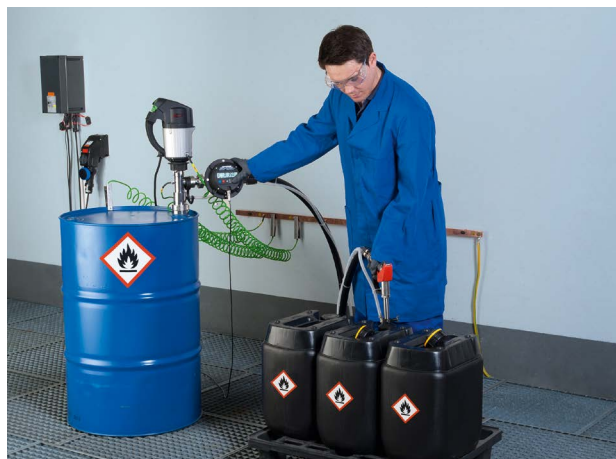
Полуавтоматическое наполнение резервуаров во взрывоопасной зоне 1.
