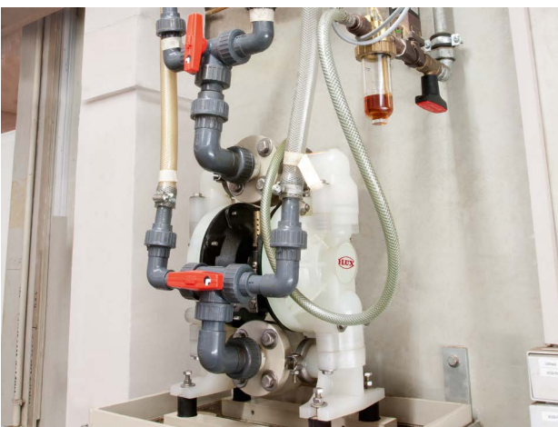
FDM Выкачивание химического никеля для гальванической ванны.
