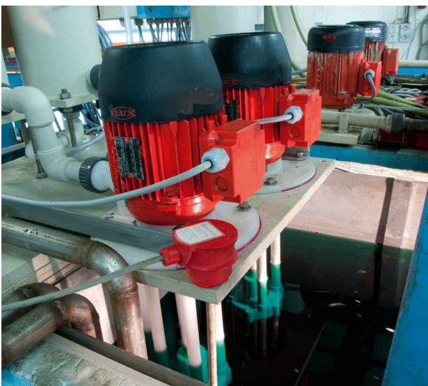
F 716 Циркуляция химикатов в ванне с электролитом.
