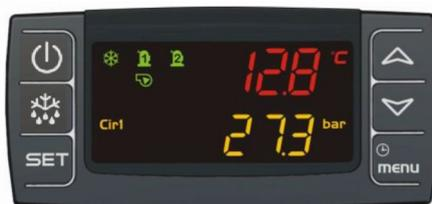
**Верхние цифры (красного цвета):** зависят от параметра CF36 (PB1, PB2, PB4, уставка (значение параметра)\*, рабочая уставка (фактическая уставка, полученная на основании динамической уставки)).
