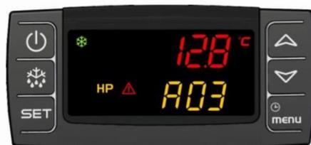
Когда прибор обнаруживает аварийное состояние, в нижней части дисплея попеременно отображается код сигнализации и показания датчика; мигает значок сигнализации (▲).
