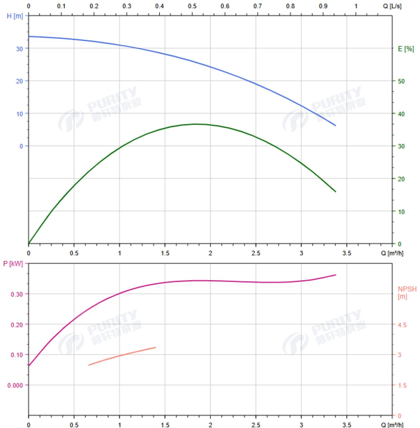
Измерения произведены для чистой воды, температурой  $20^\circ\text{C}$  и вязкостью  $1 \text{ mm}^2/\text{s}$ .
