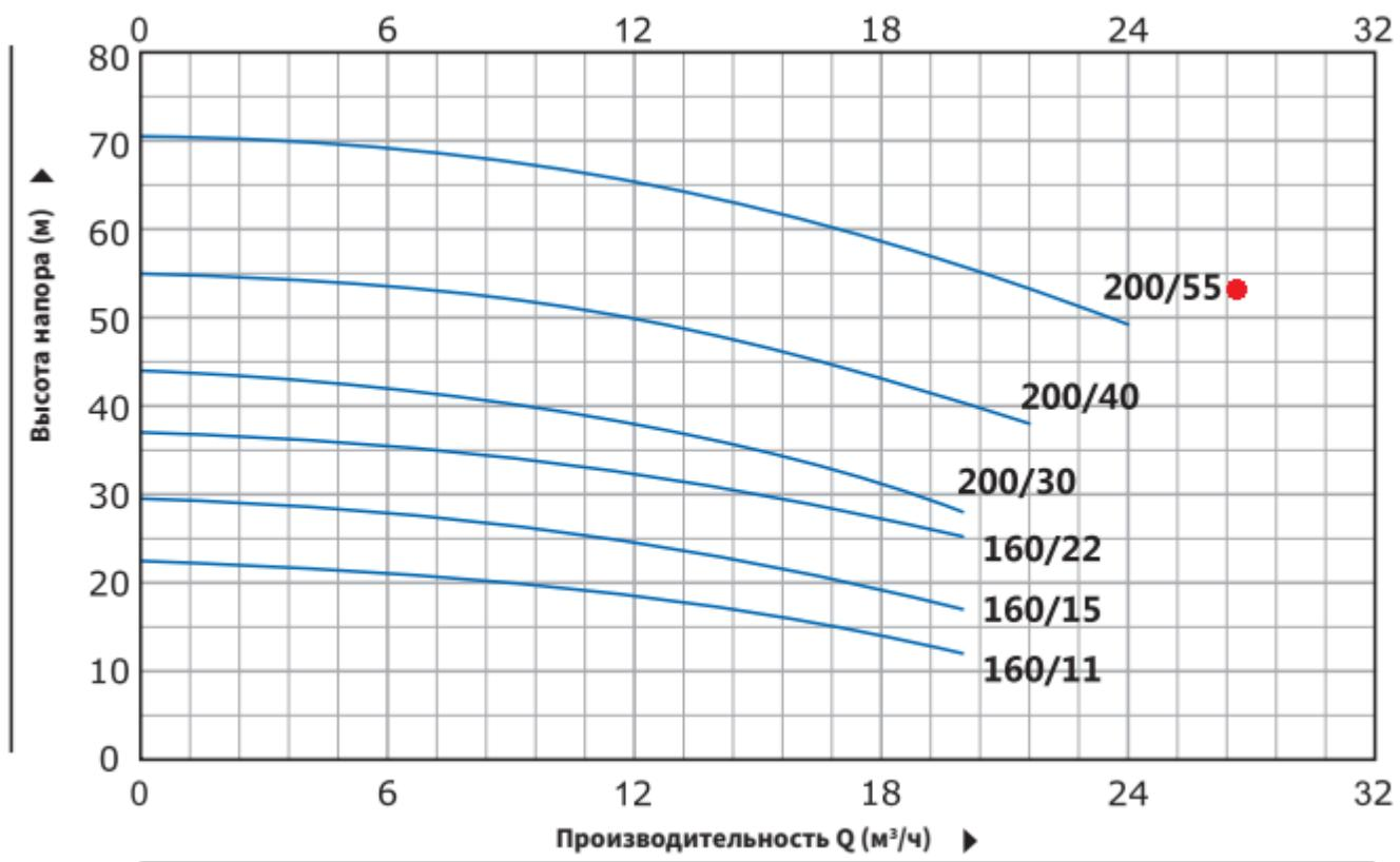
Измерения проводились для чистой воды, температурой 20°C и вязкостью 1 мм²/с.
