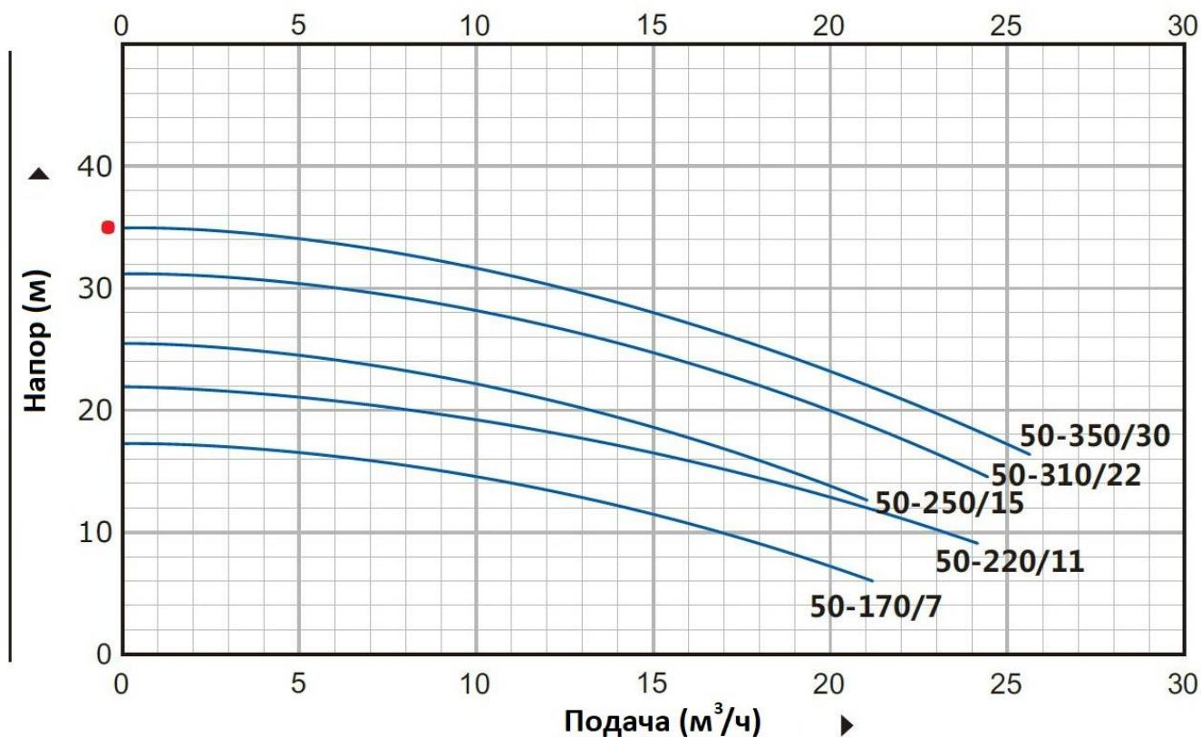
Пояснение к графикам: Напор (м) – напор в метрах водяного столба, Подача ( $\text{м}^3/\text{ч}$ ) – подача в метрах<sup>3</sup> в час,
