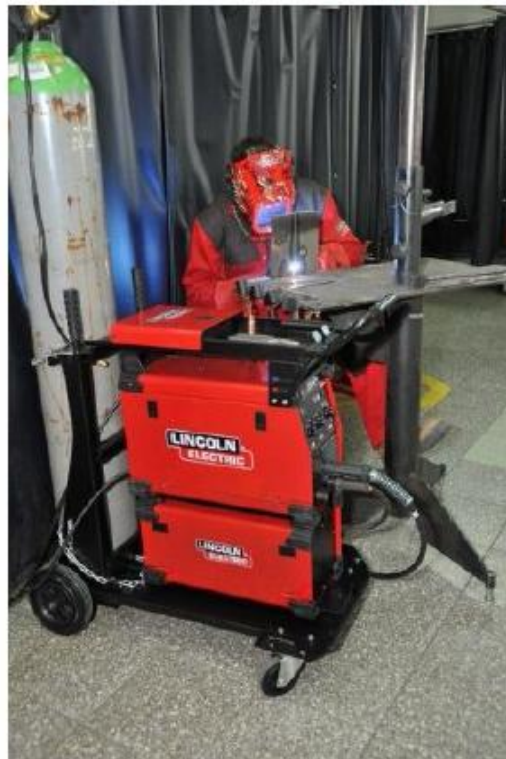
Speedtec 180C, мягкая сталь, MIG, 1,0mm, Ar MIX
