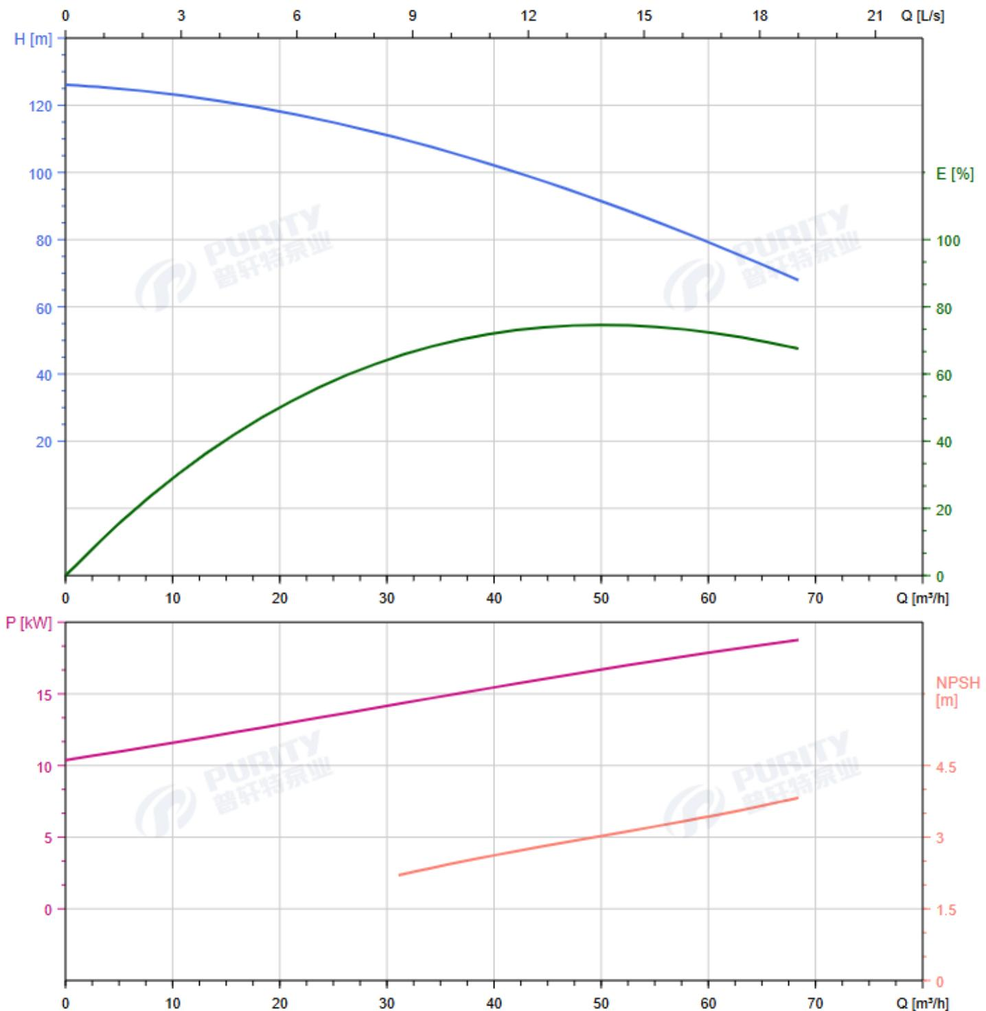
Измерения произведены для чистой воды, температурой 20°C и вязкостью 1  $\text{мм}^2/\text{с}$ .
