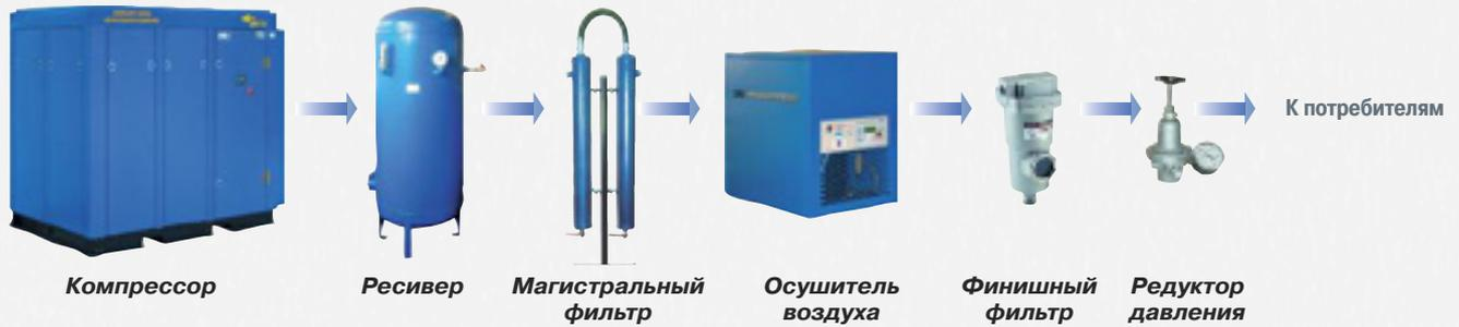
Подготовка сжатого воздуха производится для достижения следующих целей: очистка воздуха от загрязнений, очистка воздуха от влаги, обеспечение заданного давления.
