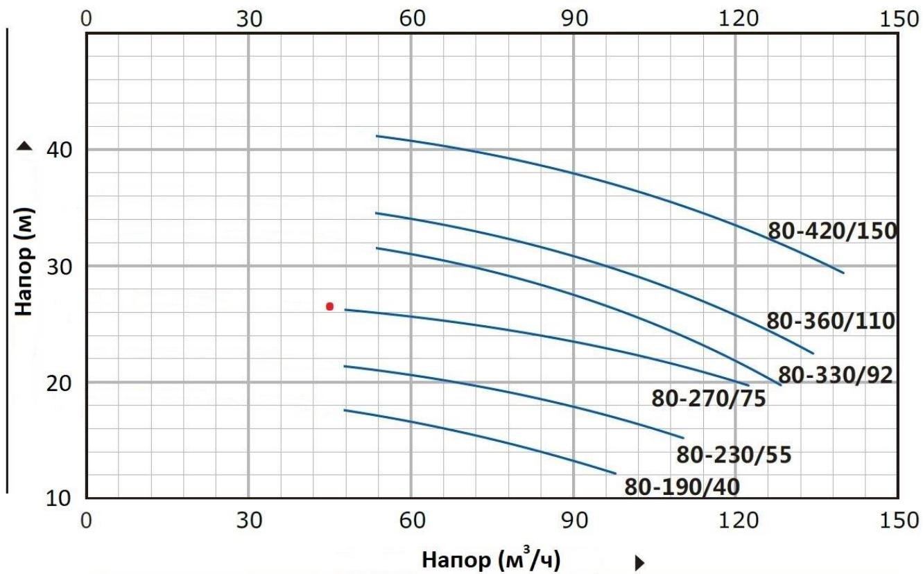
Пояснение к графикам: Напор (м) – напор в метрах водяного столба, Подача (м<sup>3</sup>/ч) – подача в метрах<sup>3</sup> в час,
