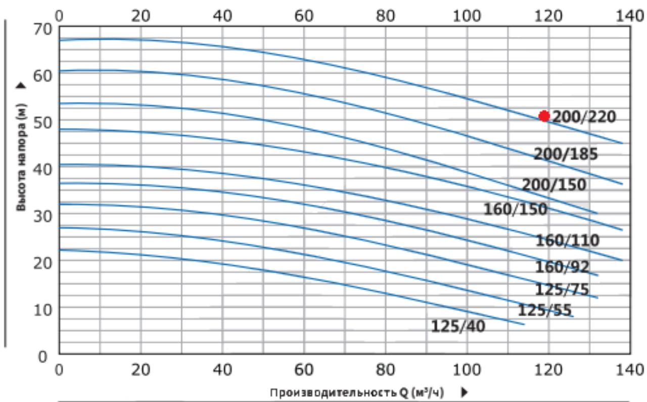
Измерения проводились для чистой воды, температурой 20°C и вязкостью 1 мм<sup>2</sup>/с.
