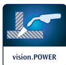
**vision.POWER** для концентрации дуги и глубокого проплавления
