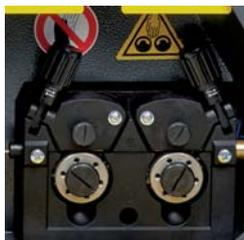
Аппараты CONVEX 420 YARD могут использоваться с соединительными кабелями длиной до 50 м, при этом управление параметрами производится напрямую с подающего механизма
