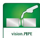
**vision.PIPE** для формирования аккуратного корневого шва при первом проходе при сварке труб
