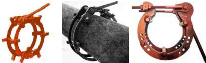
Центратор ЦНЭ состоит из двух или трех дуг с опорами, соединенных между собой осями, и эксцентрикового зажима. Путем применения проставок или перестановки осей каждый центратор используется для труб нескольких диаметров.
