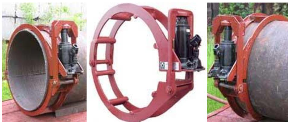
Центратор ЦАН-Г состоит из двух или трех дугообразных, шарнирно связанных между собой секций. Количество секций определено конструктивно в зависимости от диаметра центрируемой трубы. Каждая секция имеет упоры, которыми обеспечивается симметричность взаимного расположения торцов труб. На консоли секции закреплен гидропривод центратора с максимально развиваемым усилием от 3 до 5 т.с. С нижней секцией шарнирно связан захват предназначенный для замыкания силовых секций центратора.
