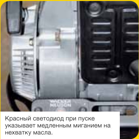
Четырехтактный двигатель WM 100 от компании Wacker Neuson.
