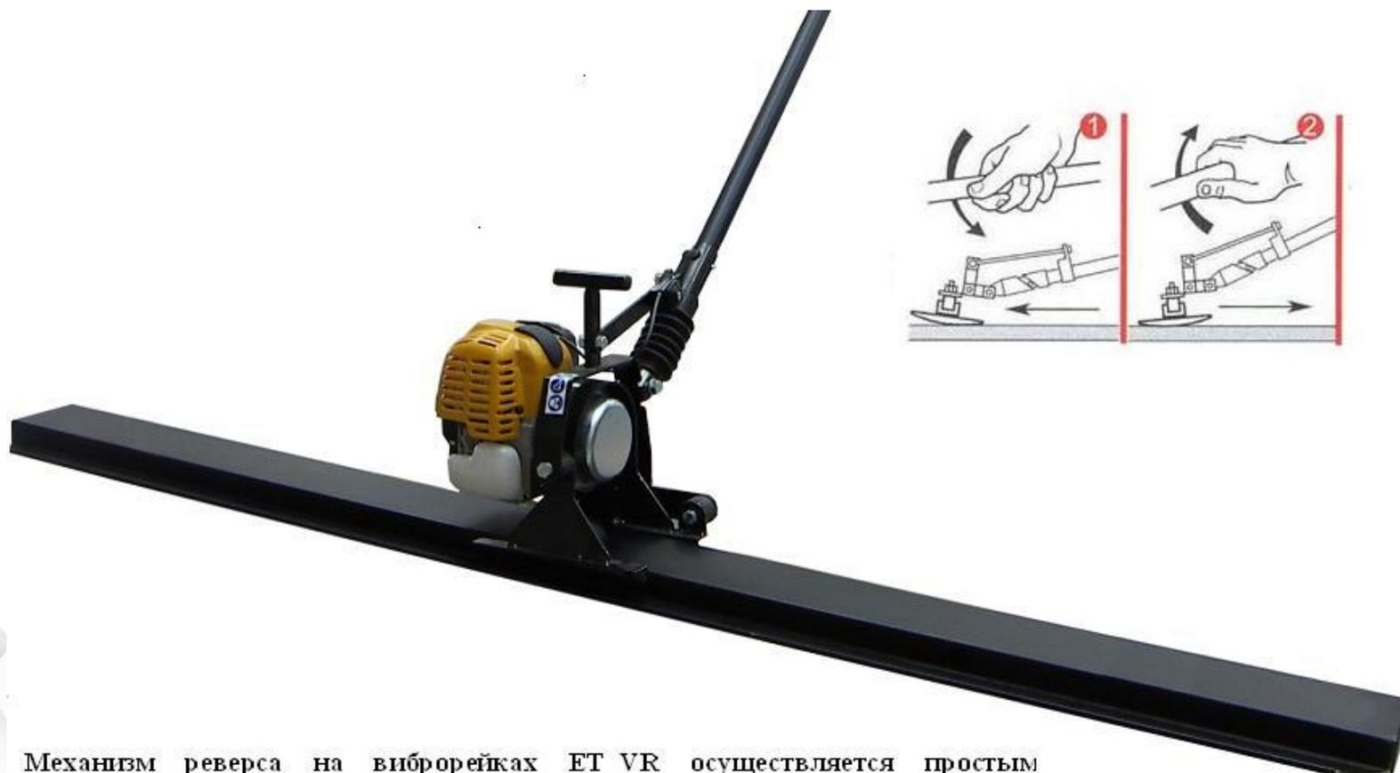
Механизм реверса на виброрейках ET\_VR осуществляется простым поворотом ручки. Повернув ручку направо можно изменить направление профиля до получения требуемого угла и производить работу по направлению вперед.
