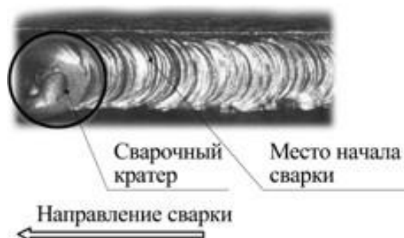
Рис. 9.3. Начало сварки при смене электрода.
