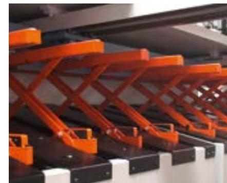
**Пневматическая система поддержки листа Х-образного типа (опцион)**
