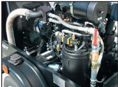
🟡 **Нагреватель сжатого воздуха.** Сжатый воздух, проходящий через теплообменник и терморегулятор, подогревается выхлопными газами двигателя до высокой температуры и предотвращает образование льда и замерзание отбойных молотков в зимнее время.
