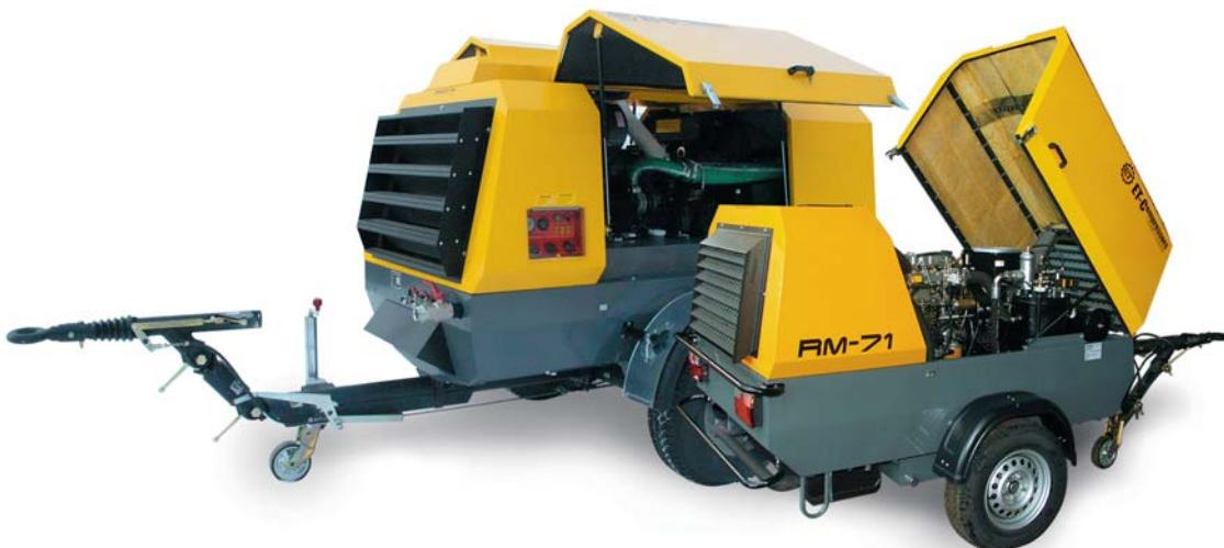
Основные элементы компрессора — двигатель и винтовой элемент — соединены при помощи картера, который обеспечивает соосность между маховиком двигателя и валом компрессора. Крутящий момент передается от двигателя к компрессору через упругую соединительную муфту, что гарантирует большой ресурс передачи и облегчает техническое обслуживание.
