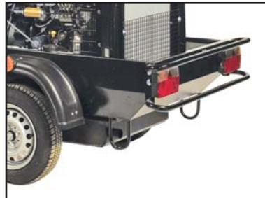
🟡 **Комплект оборудования BS.** Предназначен для работы с пескоструйными аппаратами. Состоит из дополнительного охлаждающего радиатора с сепаратором, который удаляет основную часть влаги (порядка 85%) из сжатого воздуха и поддерживает температуру сжатого воздуха на 15 °C больше температуры окружающей среды, что оптимально для пескоструйного аппарата.
