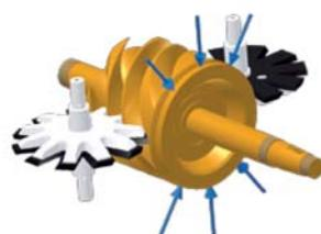
Радиальные нагрузки действуют сверху и снизу главного винта
