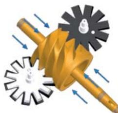
Оевые нагрузки действуют с обеих сторон главного винта
