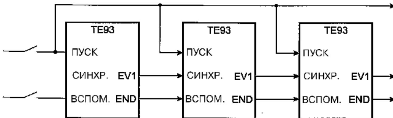
Начало цикла определяется подачей сигнала начала цикла на входы SYNC и AUX. Условия, определяющие начало цикла, различны для различных режимов работы. Функции каждого входа в зависимости от различных режимов работы описываются ниже.
