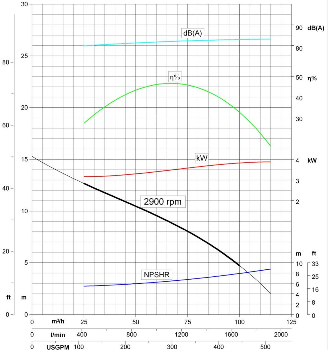
dB(A)=max livello sonoro ad 1 m. / dB(A)=max noise level at 1 m.
