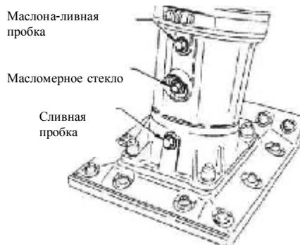
Рис. 13. Сливная пробка корпуса подошвы
