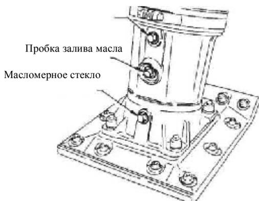
1. По масломерному стеклу проверьте уровень масла (Рис. 2) на задней стороне основания трамбовки.
