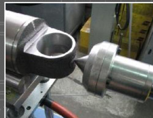
*Автоматическая MIG сварка кольцевых швов гасителей колебаний (амортизаторов)*
