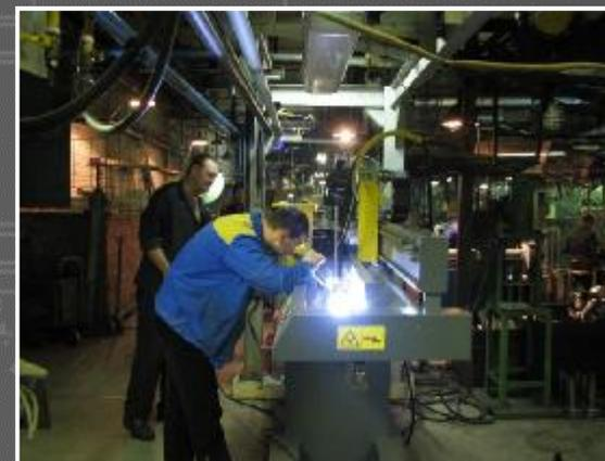
Автоматизация технологии плазменной сварки, машина для сварки продольных швов
