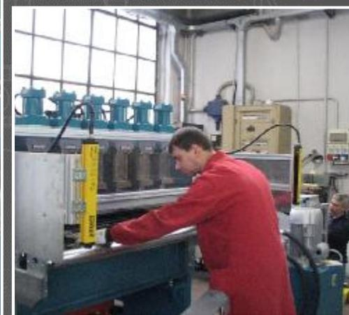
Машина для приварки пластин обрамления способом рельефной контактной сварки
