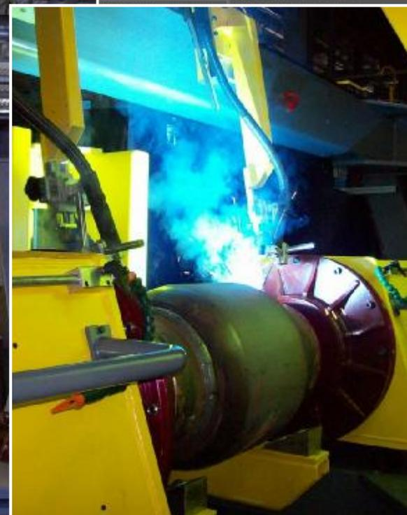
*Машина для сварки двух кольцевых швов корпуса крана (Ду300 - Ду600)*
