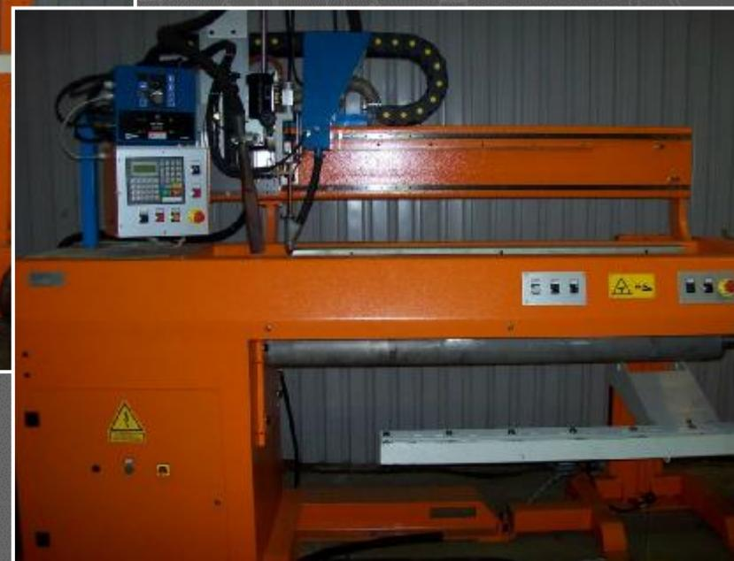
Автоматизация технологии сварки под флюсом, машина для сварки продольных швов и машина для сварки кольцевых швов
