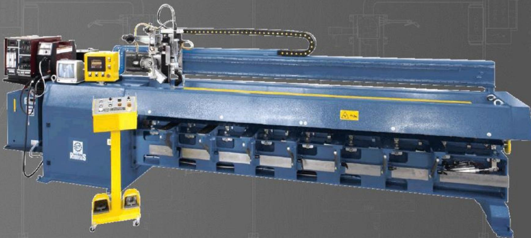
*Автоматизация технологии плазменной сварки, машина для сварки продольных швов карт и обечаек*
