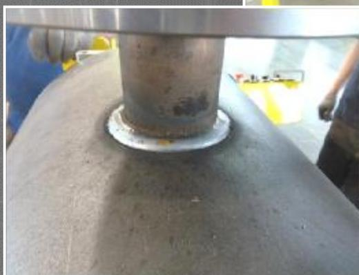
Машина для приварки втулки штока к корпусу шаровых кранов
