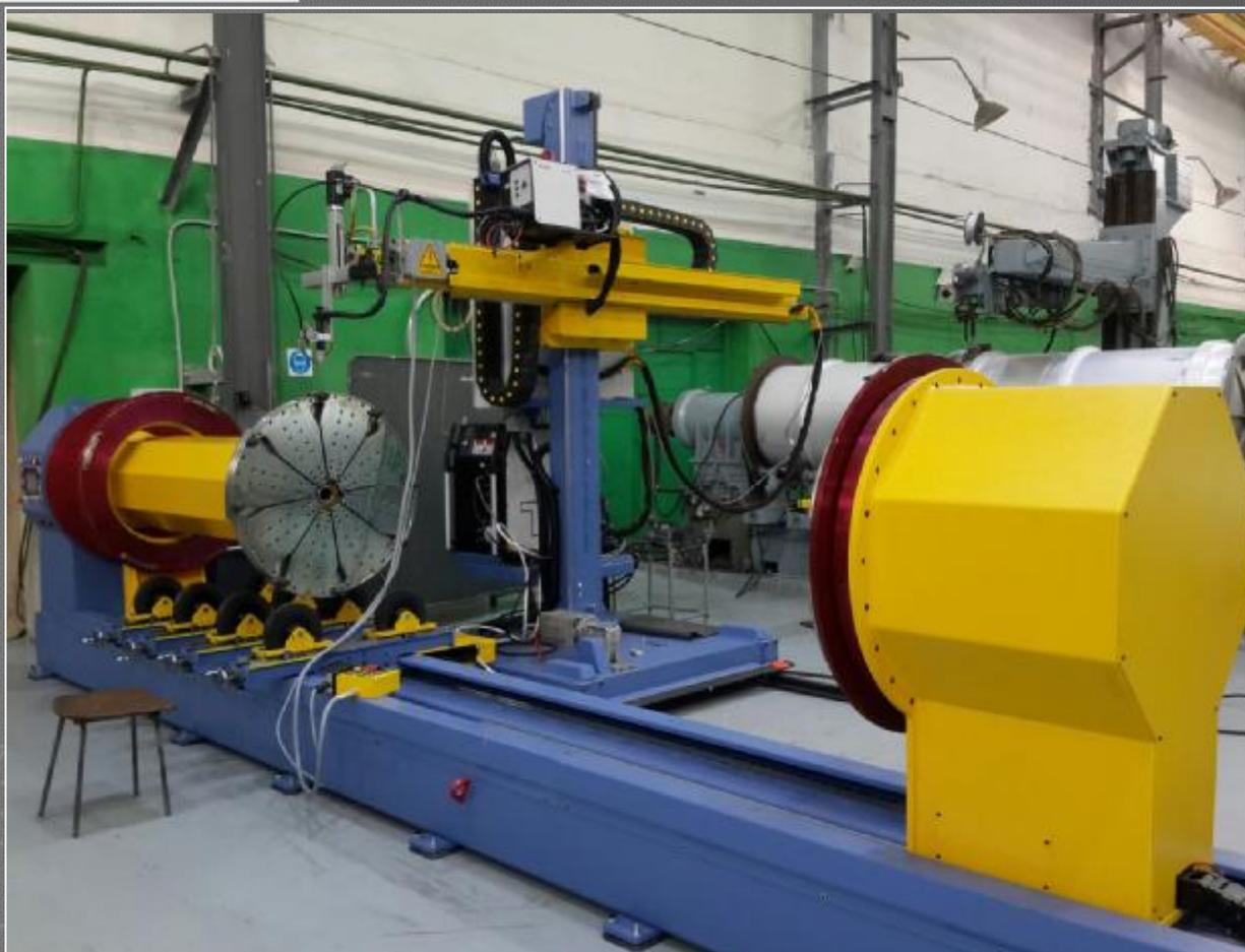
Машина для TIG сварки кольцевых швов алюминиевых обечаек длиной до 9 м
