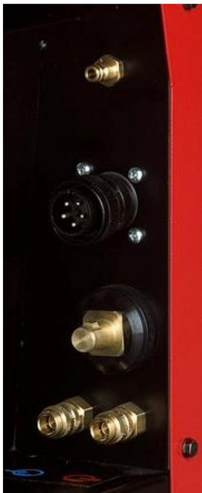
Фитинг для подключения газового шланга
