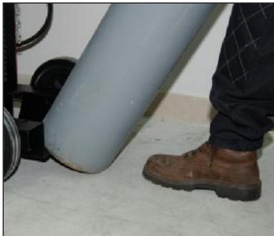
Чтобы облегчить установку баллона, на тележке Speedtec ,площадка для баллона установлена низко.
