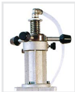
Регулируемый маховиком двойной ход 0-80 мм для цилиндра с усилием 736 даН Арт. 8236
