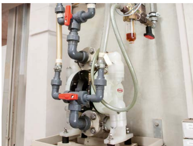
FDM Выкачивание химического никеля для гальванической ванны.
