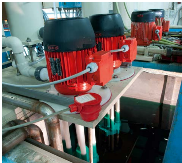
F 716 Циркуляция химикатов в ванне с электролитом.
