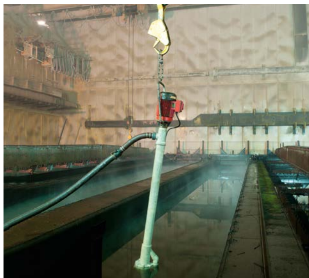
F 640 – Выкачивание разбавленной серной кислоты.
