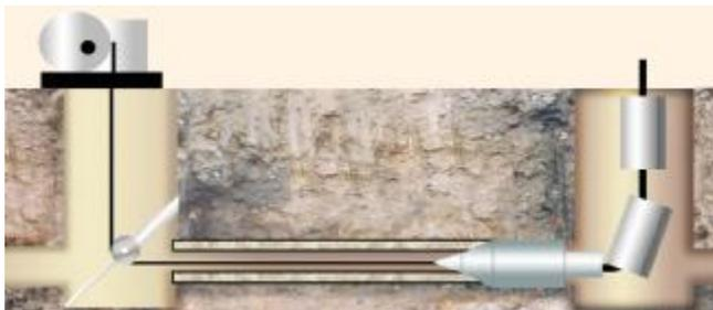
**а) сталь, ковкий чугун** Существующая труба выбивается из скважины при помощи пневмопробойника или машины для забивания труб. На ее место (в готовую скважину) при помощи лебедки затягивается новая труба. В случае, если необходимо заменить старую стальную трубу на новую стальную (того же диаметра или больше), возможно выбивание старой трубы непосредственно новой. При разнице в диаметрах используется переходник (насадка).
