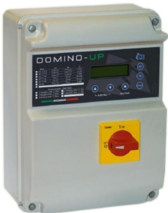
**Электронный пульт с дисплеем, управление 1** однофазным или трехфазным насосом для чистой или грязной воды. Защита от сухого хода по  $\cos \phi$
