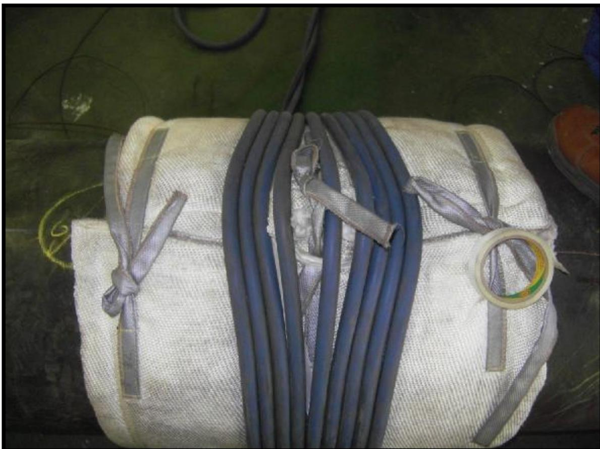
Витки индуктора, при необходимости, легко раздвигаются для выравнивания температуры нагрева. При сварке патрубка, см. предыдущее фото, витки обмотки поверх изоляции слегка раздвинуты для равномерного нагрева.
