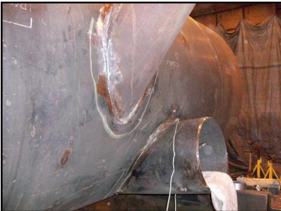
Подготовленная обмотка , показанная на предыдущем фото, опускается в трубу (врезка под углом) для нагрева “изнутри” Индукционная обмотка закреплена на пластиковую трубу меньшего диаметра, чтобы осталось место для изляционного материала, защищающего индуктор.
