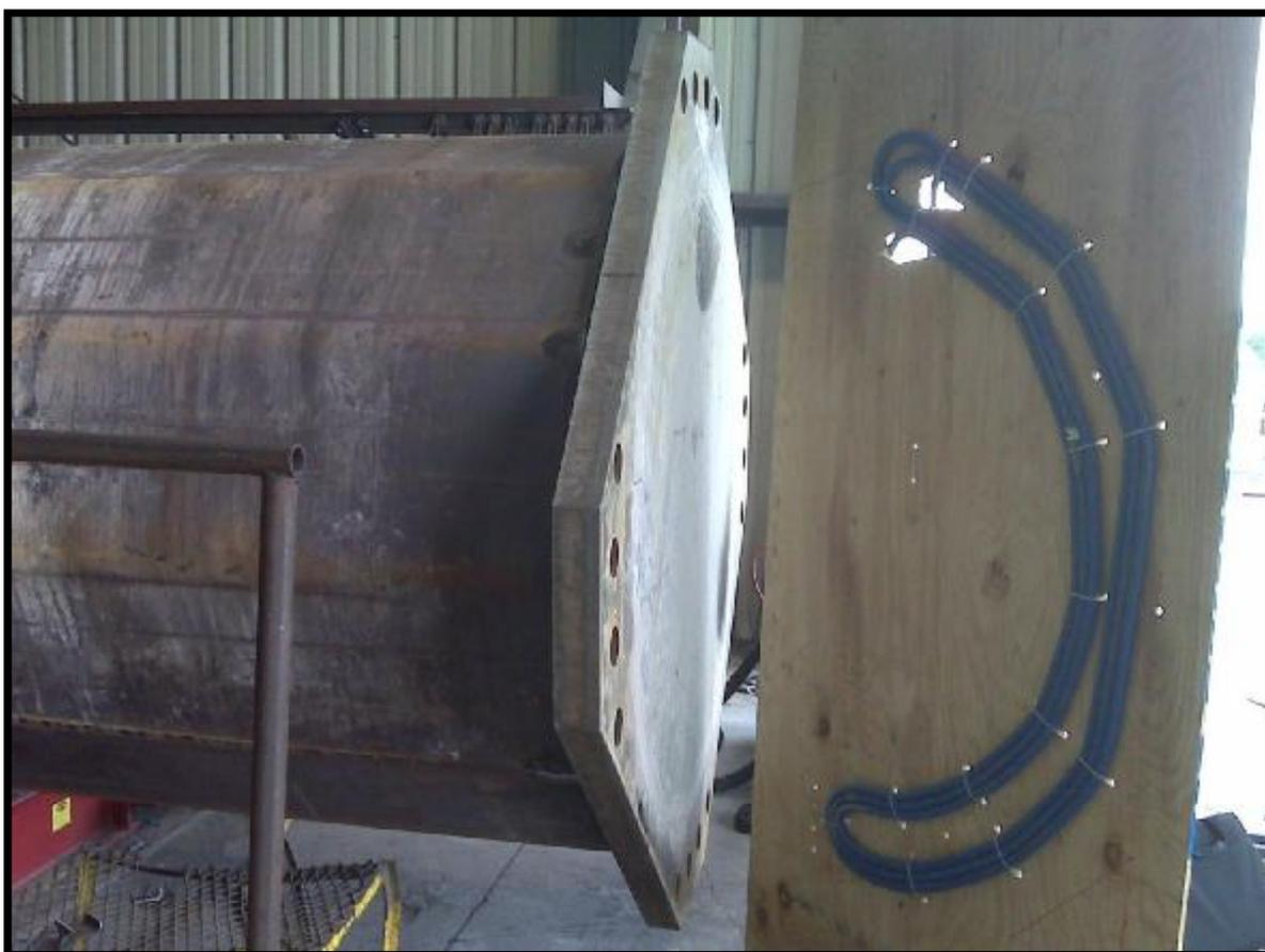
Для производства опор и башен необходим нагрев поворотных стыков при сварке толстостенного основания и формованного цилиндрического корпуса. На фото - заготовка обмотки для нагрева основания с обратной стороны .
