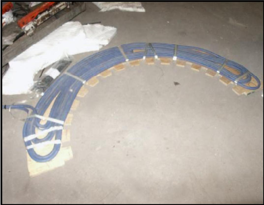
Обмотки часто изобретаются технологами для повторения геометрии нагреваемых деталей. С учетом, что предварительный нагрев требует лишь 204 С , неметаллические материалы, например фанера, могут применяться для крепления кабелей индуктора.
