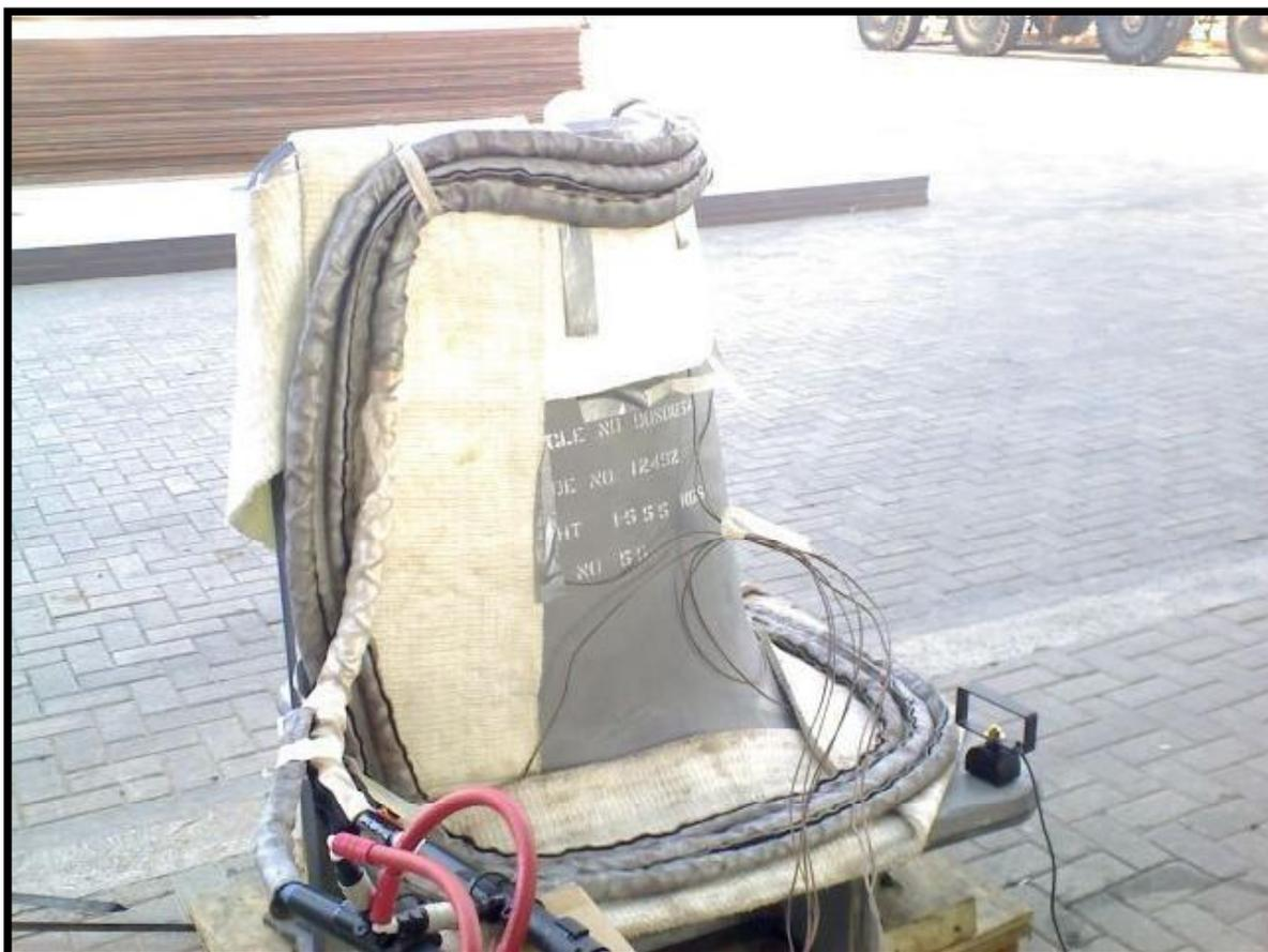
Данная чугунная заготовка требует нагрева по периметру перед сваркой.
