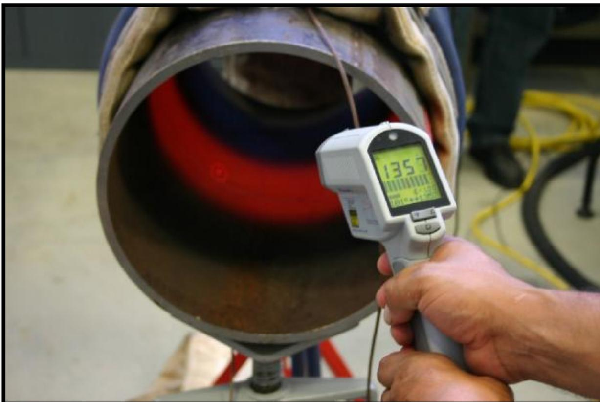
При использовании индукционного нагрева на испытываемой трубе, показания температуры одинаковы на отметках “12 часов” и на отметке “6 часов”.
