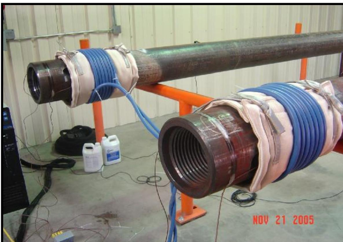
При использовании одного кабеля можно нагреть не один, а несколько участков, при условии, что геометрия деталей и требование к нагреву – одинаковы. В данном примере, использован один кабель, от одного из выходных терминалов аппарата, для нагрева одинаковых элементов, приваренных к одинаковым трубам. Однако, по возможности, необходимо закрывать заглушками концы труб для сохранения тепла.
