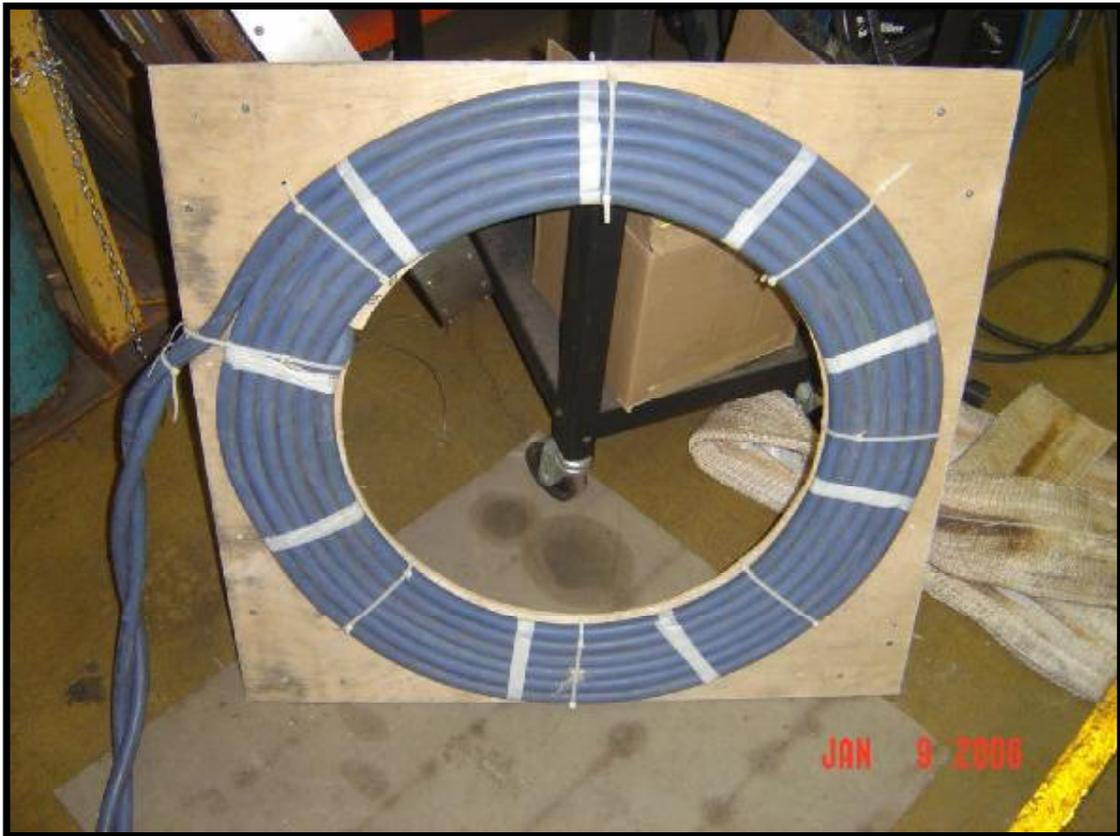
Эта круглая , но “плоская” обмотка в форме “баранки” была создана для нагрева стыка для сварки тонкостенного круглого основания и тонкостенной трубы
