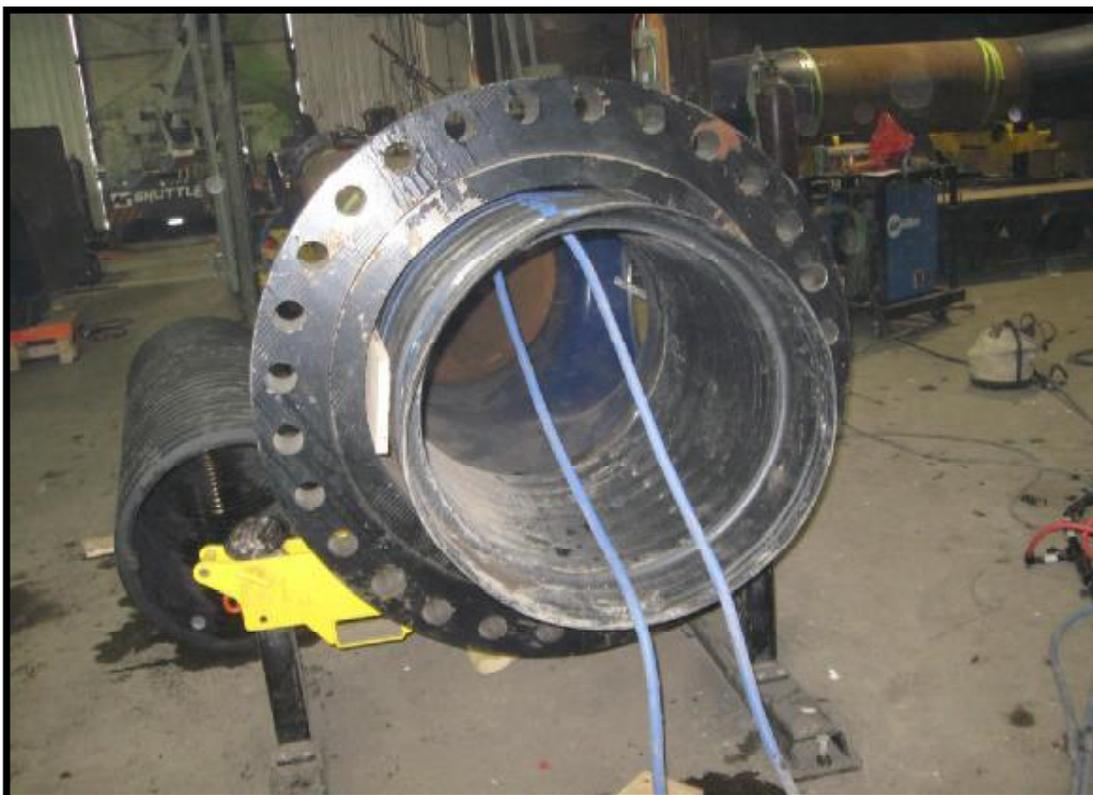
Внутреннее расположение закрепленной обмотки в месте стыка фланец/труба, позволяет производить нагрев “изнутри” и не мешает сварке стыка “снаружи”. Спейсеры используются для равномерного воздушного зазора между обмоткой и внутренним диаметром соединения. Аналогичные обмотки, частенько закрепляются на стационарных стендах для создания возможности сварки поворотных стыков.
