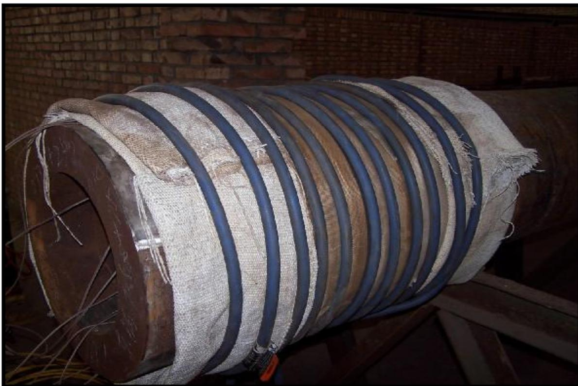
Витки необязательно должны быть расположены плотно друг к другу. Часто длина кабеля индуктора недостаточна для нагрева широкой зоны, если витки плотно намотаны. На этом фото, обмотка показана с витками на расстоянии 75-100мм друг от друга. Макс. нагрев находится под кабелем, но температура нагрева всей зоны между витками медленно выравнивается, по истечении времени.
