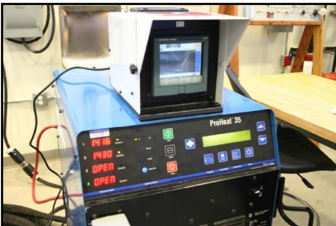
Высокотемпературная обработка характерна при сварке труб из легированных сталей с 9% содержанием хрома, параметры снимаемые с 2-х термопар, указывают температуру выше 760 С. Обратите внимание, что электронное записывающее устройство регистрирует скорость нагрева до температуры “выдержки” и очень аккуратно регистрирует температуру во время выдержки.
