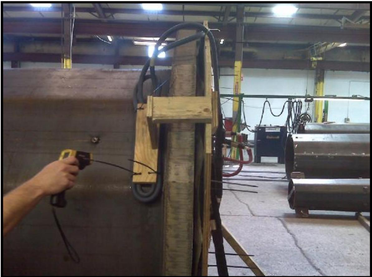
Это вид позволяет рассмотреть положение обмоток нагрева поворотных стыков, не мешающих вращению всей конструкции. Сталь нагревается по мере вращения и прохождения мимо обмоток, зафиксированных стационарно.
