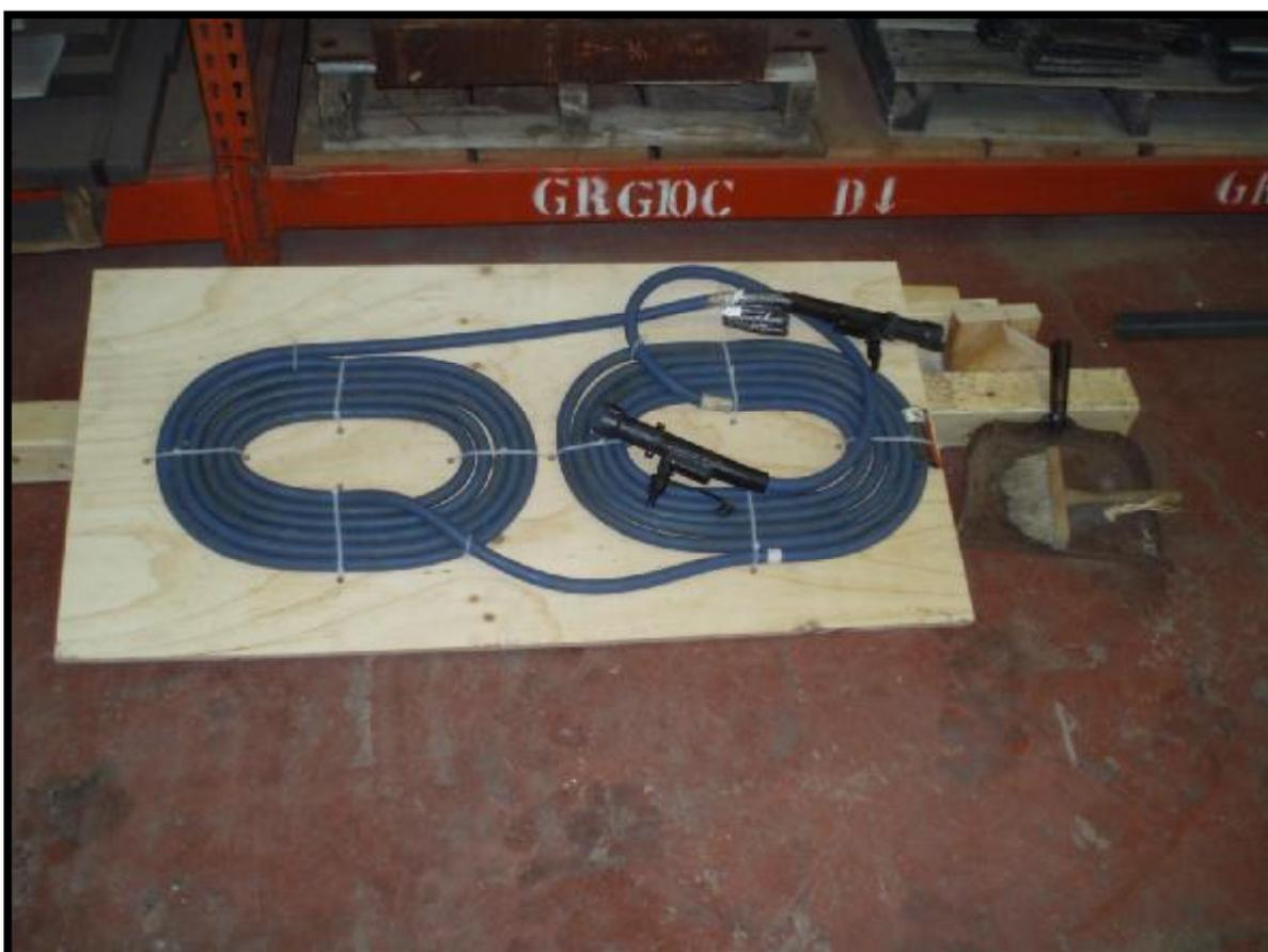
Обмотка в виде двух “баранок” разложена для подготовки предварительного нагрева листов в “движении”, с перемещением обмотки впереди движущейся горелки для автоматической сварки под флюсом. Proheat может нагревать листовую сталь 25мм до  $T$  свыше  $+121\text{ C}$  в движении, со скоростью равной стандартной скорости сварки.
