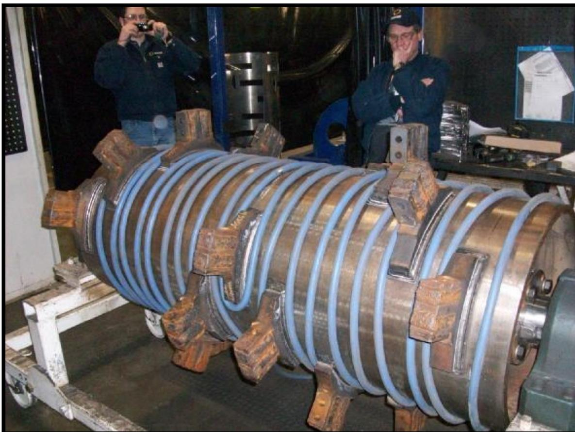
На этот вал, используемый для дробления пней больших деревьев, необходимо приварить “зубцы”. Заказчик обдумывает, как правильно расположить индуктора для равномерного нагрева вала, прежде чем он закроет его изоляционными пледами.
