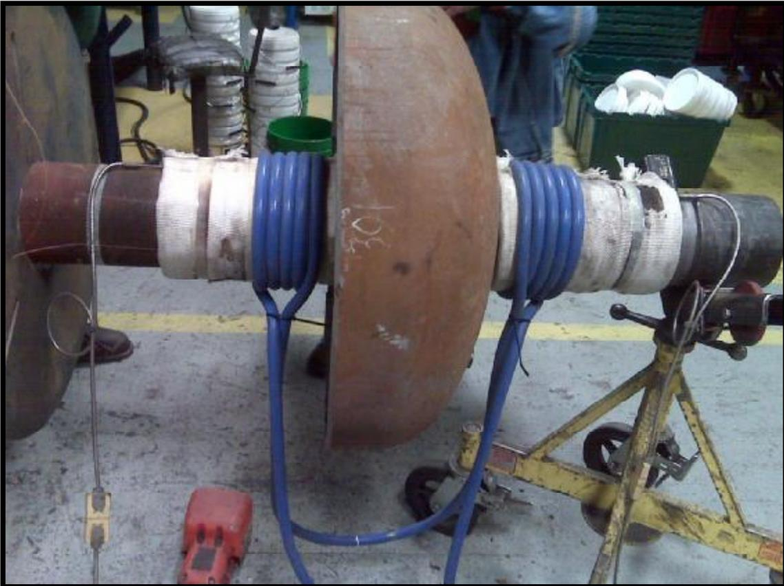
Литая цилиндрическая крышка требует нагрева в местах сварки к стальным валам. Обычно эта операция выполняется одним кабельным индуктором с формированием двух обмоток, с использованием части кабеля в виде “перемычки” на противоположную сторону.
