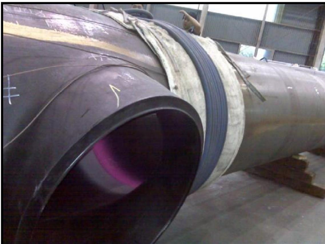
Труба большого диаметра требует локализованного снятия стрессовой нагрузки после сварки . Всегда объясняйте своим заказчикам, что дополнительная изоляция и “заглушки” на концах трубы, улучшают процесс нагрева и шансы на успешное достижение температуры “выдержки”, указанной в Техническом задании.
