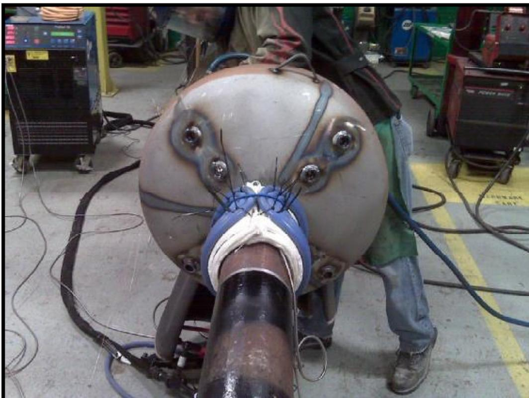
Вместо витков спирали вокруг трубы, в этом случае используется заготовка обмотки в виде вытянутой “баранки” с загнутыми краями, в виде ракушки, для быстрого снятия и повторной установки. Частота использования - диктует оптимальную форму обмотки.
