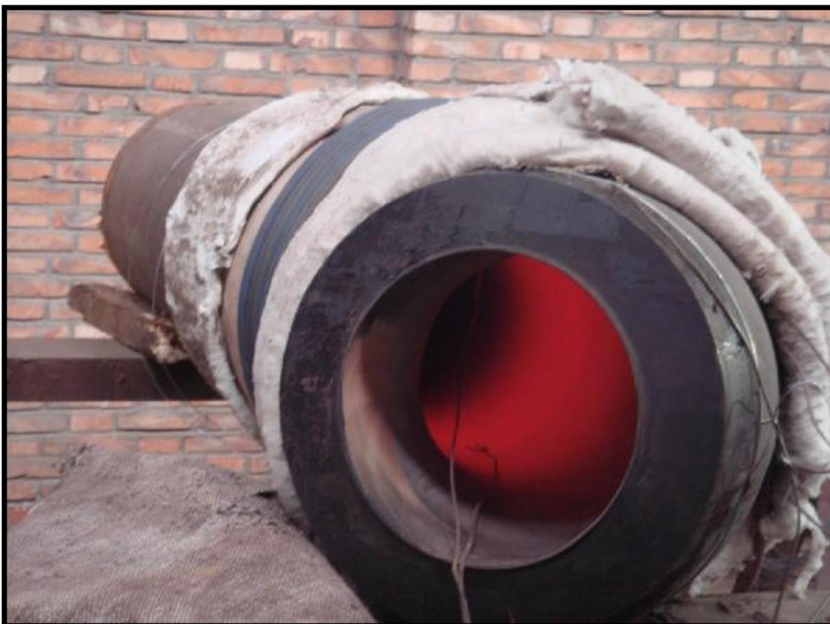
Тестовая проверка нагрева стыка толстостенной трубы (90мм, P92) до T 760C, с целью убедиться что при “выдержке” температура в районе стыка распространяется и удерживается на заданном уровне. Обратите внимание - термодатчики укреплены на стыке.
