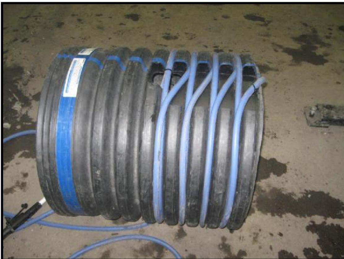
Пример 2-х уровневой фиксации индукционных кабелей с использованием направляющих гофрированной пластиковой трубы для нагрева стыка толстостенной трубы в месте приварки фланца (см. Следующее фото). Плотный контакт со сталью обеспечивает хорошее магнитное взаимодействие и использование 35-ти кВт мощности Proheat.
