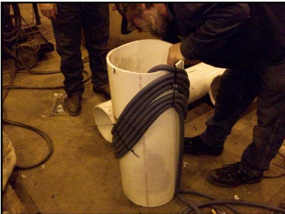
Неметаллические предметы часто используются для крепления на них гибких индукторов, для нагрева различных геометрических конструкций. Данная конфигурация расположения индукторов предназначена для нагрева стыков при врезке трубы малого диаметра в резервуар под заданным углом.
