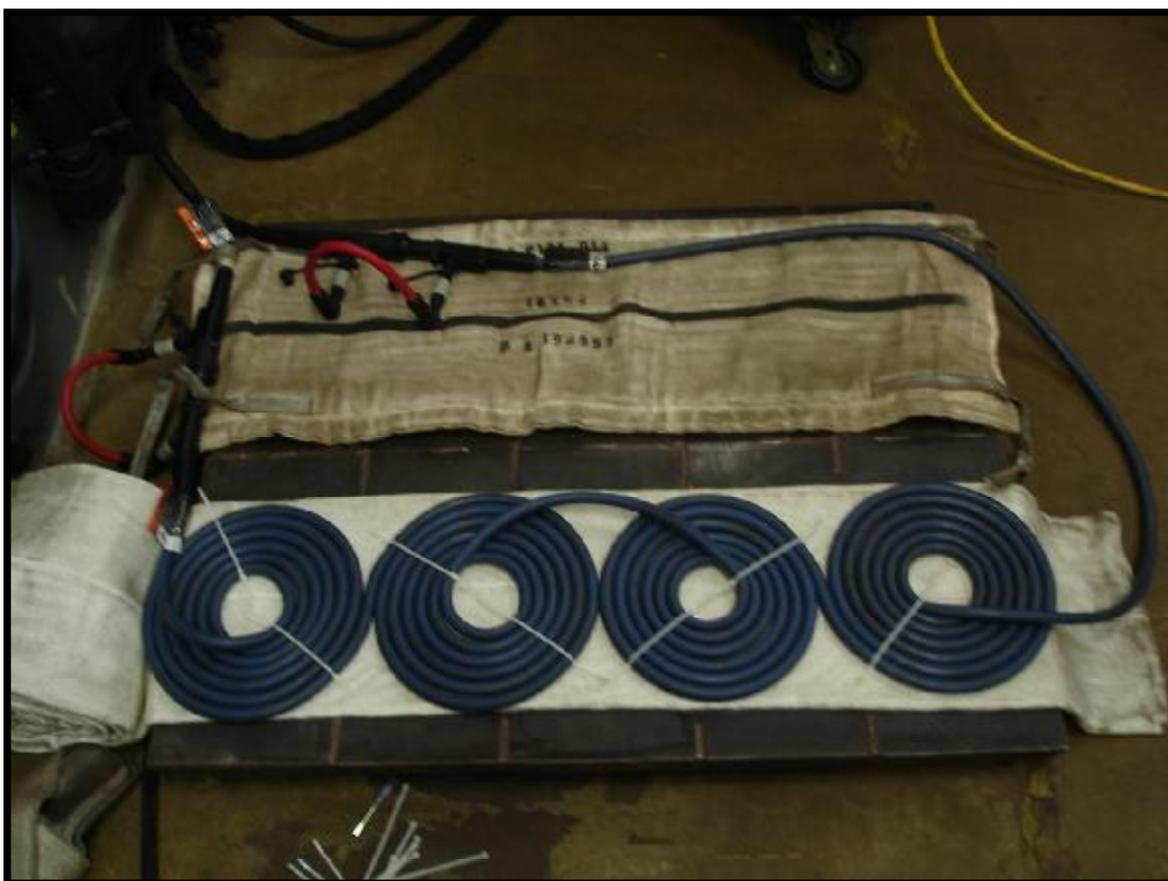
Ещё один пример подготовки обмотки для нагрева листов “в полете” – движении. Кабельные индуктора достаточно пластичны для формирования четырех круговых секций для направленного нагрева.
