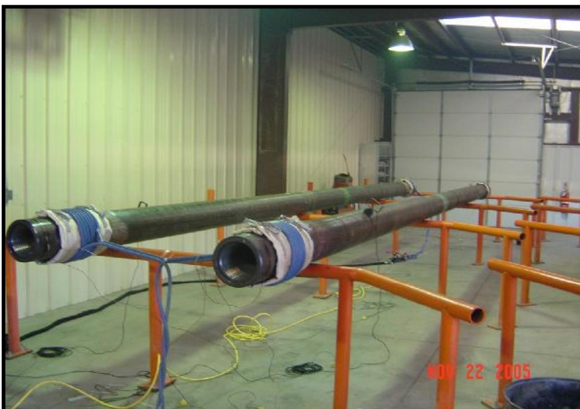
На этом примере показан одновременный нагрев 4-х участков буровой трубы, с использованием 2-х выходных терминалов источника питания и 2-х индукционных кабелей. При подключении нагрузки к обоим терминалам очень важно, чтобы геометрия и требования к нагреву деталей были одинаковыми, поскольку у Proheat отсутствует независимый контроль нагрузки каждого терминала.
