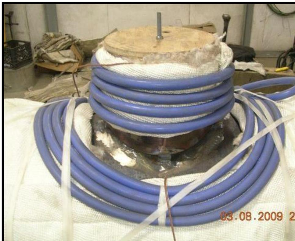
Пластичность индукторов важна для создания различных геометрических форм. В данном случае короткий отрезок трубы приваривается к трубе большего диаметра. Один индукторный кабель использован для формирования обмотки в виде “седла” на большей трубе и витков спирали на малой, оставляя достаточно места сварщику.
