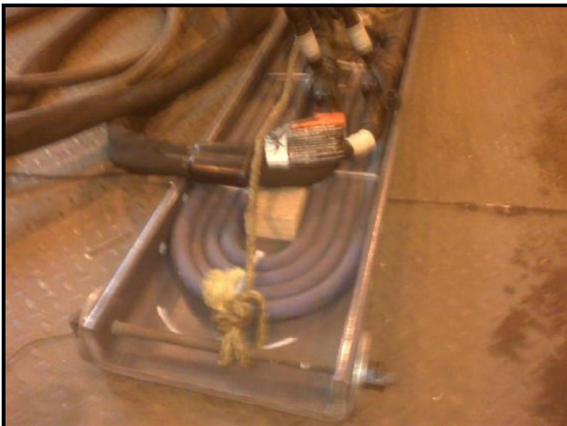
Витки индуктора успешно приспособлены для авт. сварки под флюсом, в движении, с опережением горелки. В этом исполнении, управление мощностью Proheat осуществляется не на данных температуры от термопар. Аппарат работает в “Индивидуальном” режиме с запрограммированными данными выходной мощности. Модуль сделан из термостойкого стеклопластика, оси - из углепластика и колеса из немагнитной нержавеющей стали.
