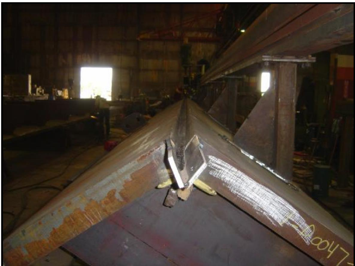
Другой пример нагрева толстостенных листов с расположением индуктора под стыком и его прижатием деревянной доской. Идет подготовка к автомат. сварке под флюсом с фиксацией стальными купонами. Два аппарата Proheat были задействованы для выполнения этого задания , поддерживая необходимую температуру на протяжении 12 часов.
