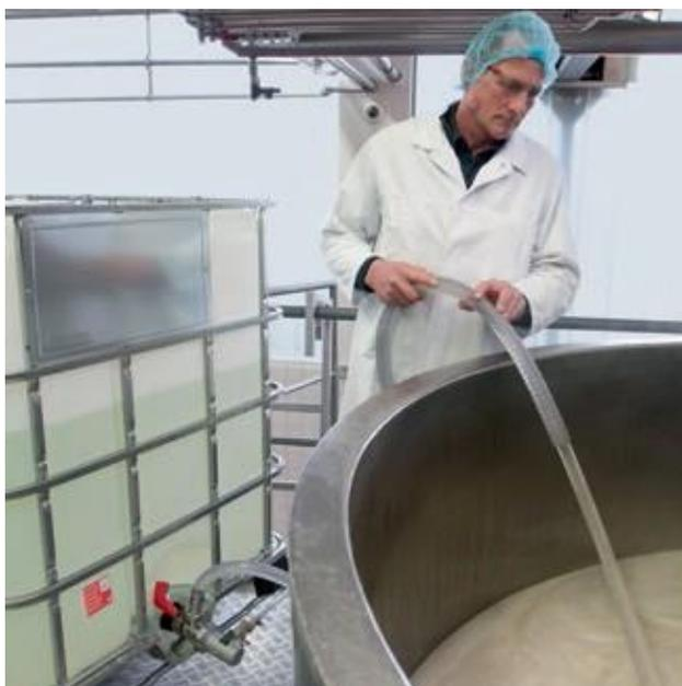
Перекачка жидкости в смесительную емкость, расположенную выше выходного отверстия контейнера IBC
