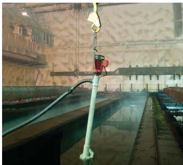
F 640 – Выкачивание разбавленной серной кислоты
