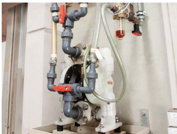
FDM Выкачивание химического никеля для гальванической ванны
