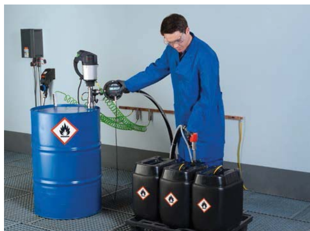
Полуавтоматическое наполнение резервуаров во взрывоопасной зоне 1
