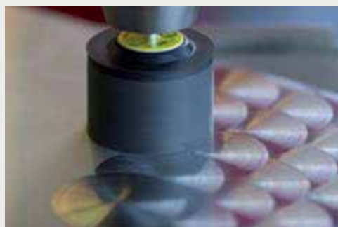
Пример тонкой шлифовки листовой стали с помощью инструмента для отделки под мрамор R-Flex SFM 656
