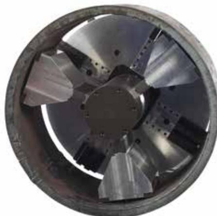
Инновационные широкие зажимы обеспечивают превосходное крепление в 6 точках внутри трубы для разделки кромок.
