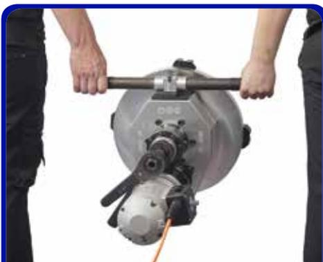
Для облегчения переноски, установки и снятия машина оснащается съемной рукояткой.
