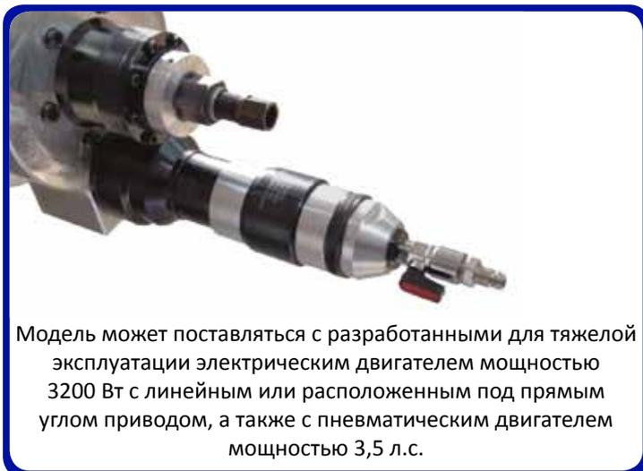
PREP 24 обладает высокой мощностью и стабильностью за счет применения системы храповых механизмов для крепления в трубе и подачи режущего инструмента.
