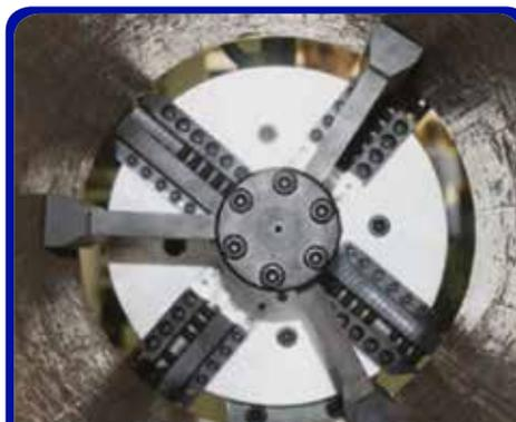
Инновационные широкие зажимы обеспечивают превосходное крепление в 6 точках внутри трубы для разделки кромок.
