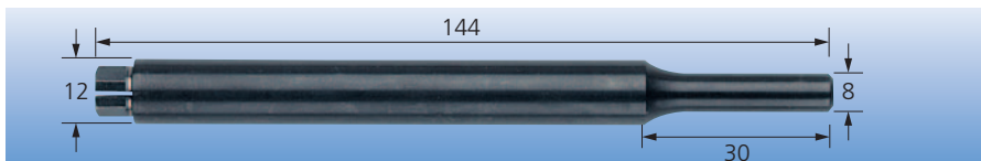
Удлинитель SPV 100-6 S8 для диаметра хвостовиков 6 мм
