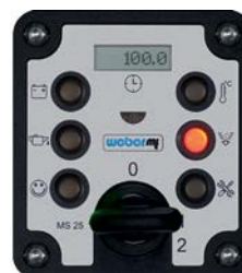
При загрязнении фильтра двигатель отключается через 10 мин.
